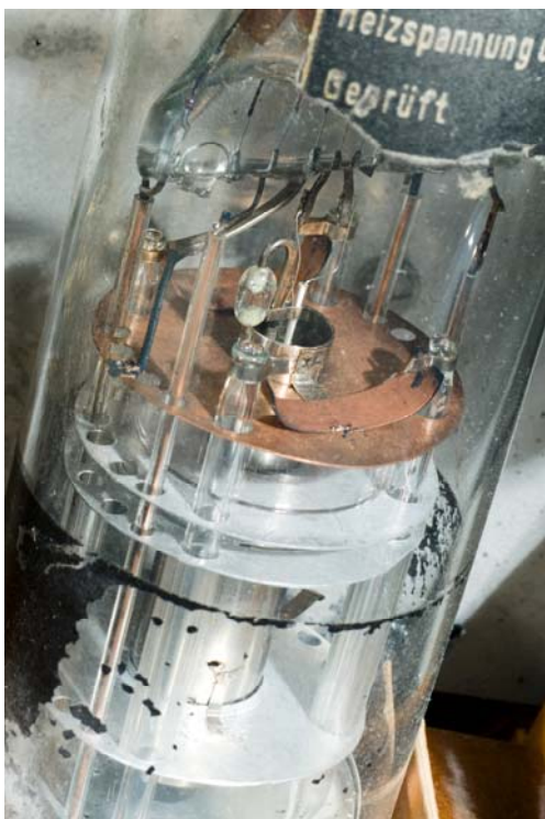
Abb. 13: Quetschfuß [Foto: H. CZECH, DM].
