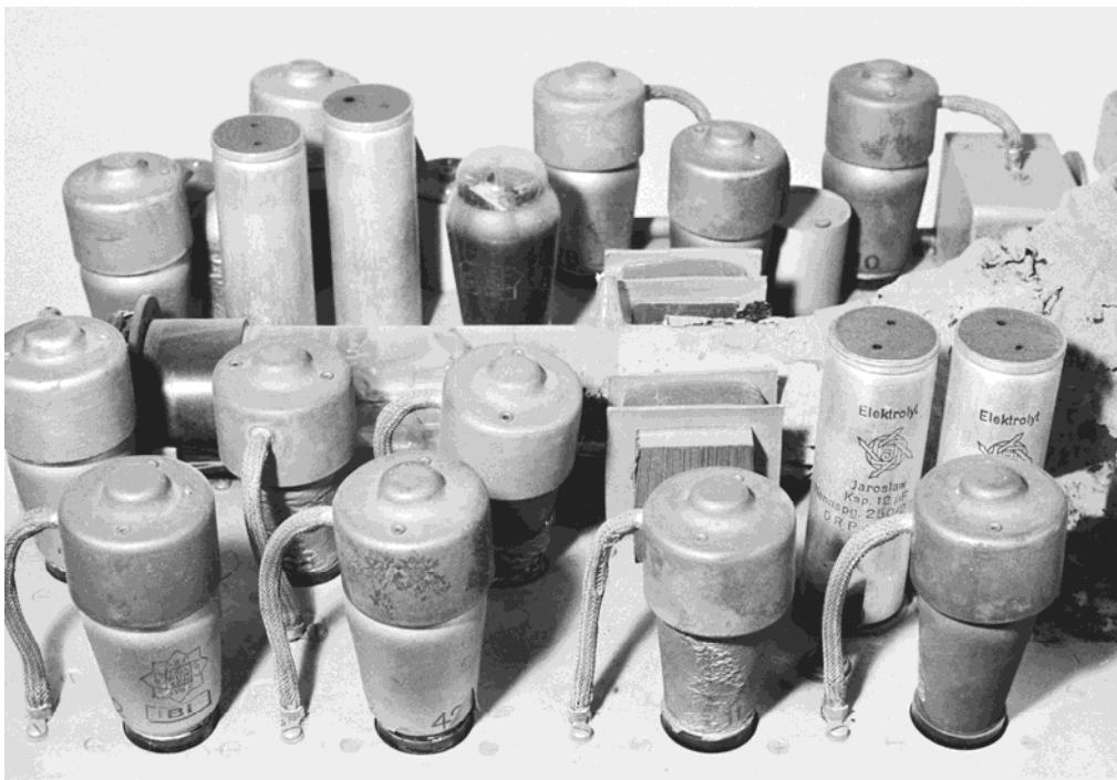
Fernsehempfänger Modell 36, Detail Elektronenröhren.
