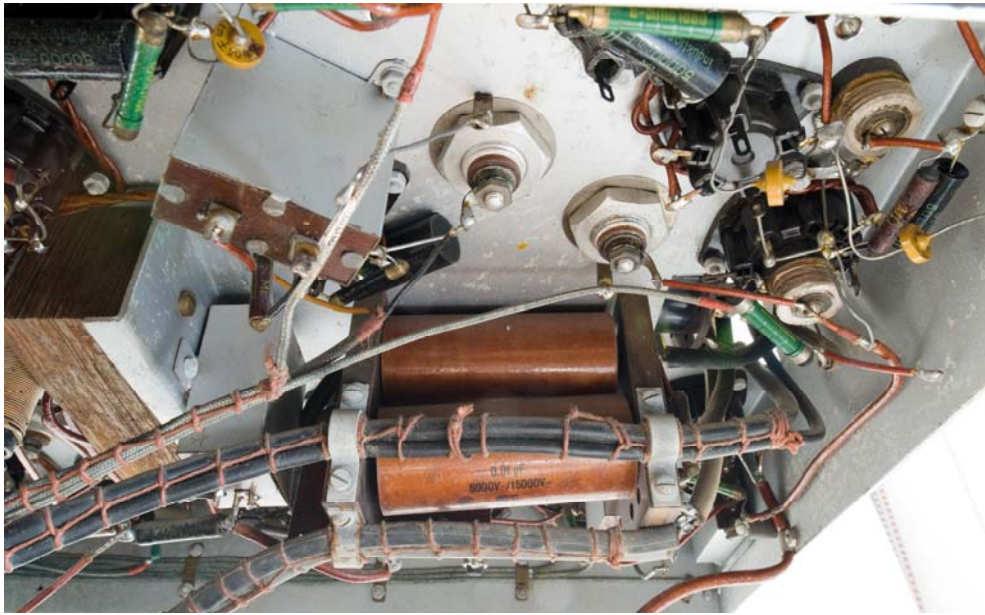
Fernsehempfänger Modell 36, Detail des Chassis von unten.
