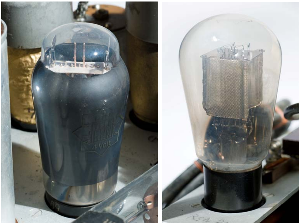
Fernsehempfänger Modell 36, Detail Elektronenröhre 15 und RGN 2004.
