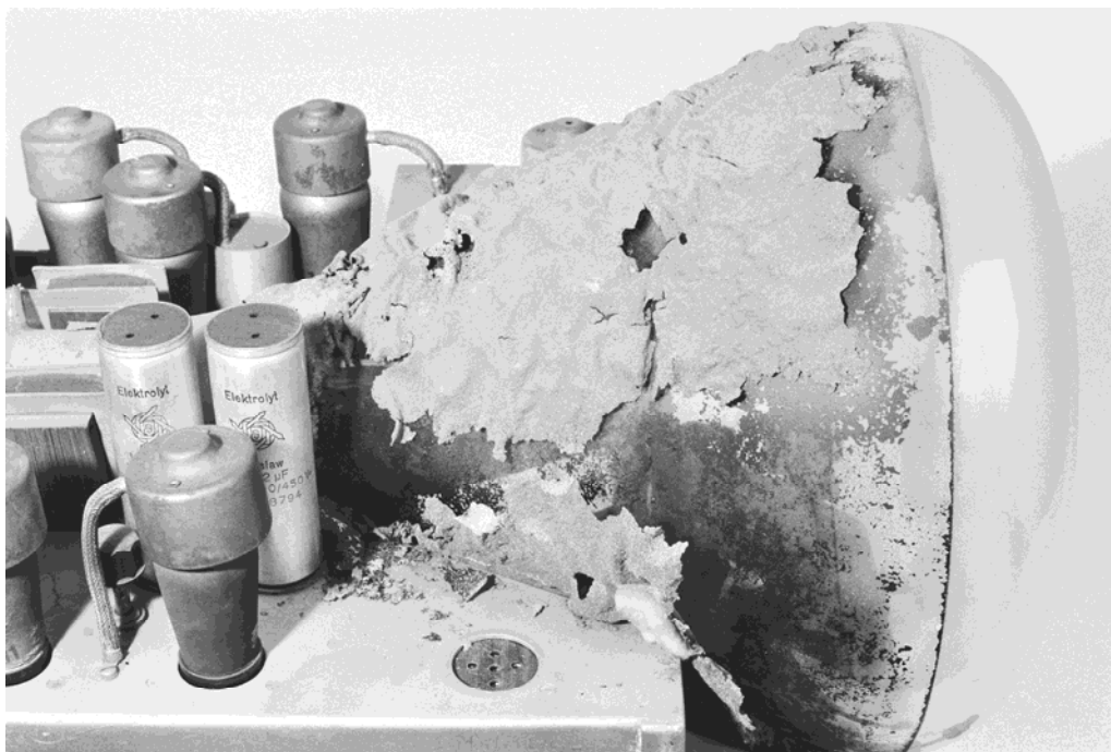
Abb. 27: Abblätternde Beschichtung der Bildröhre 1990 [Foto: E. ELLINGER, DM].
