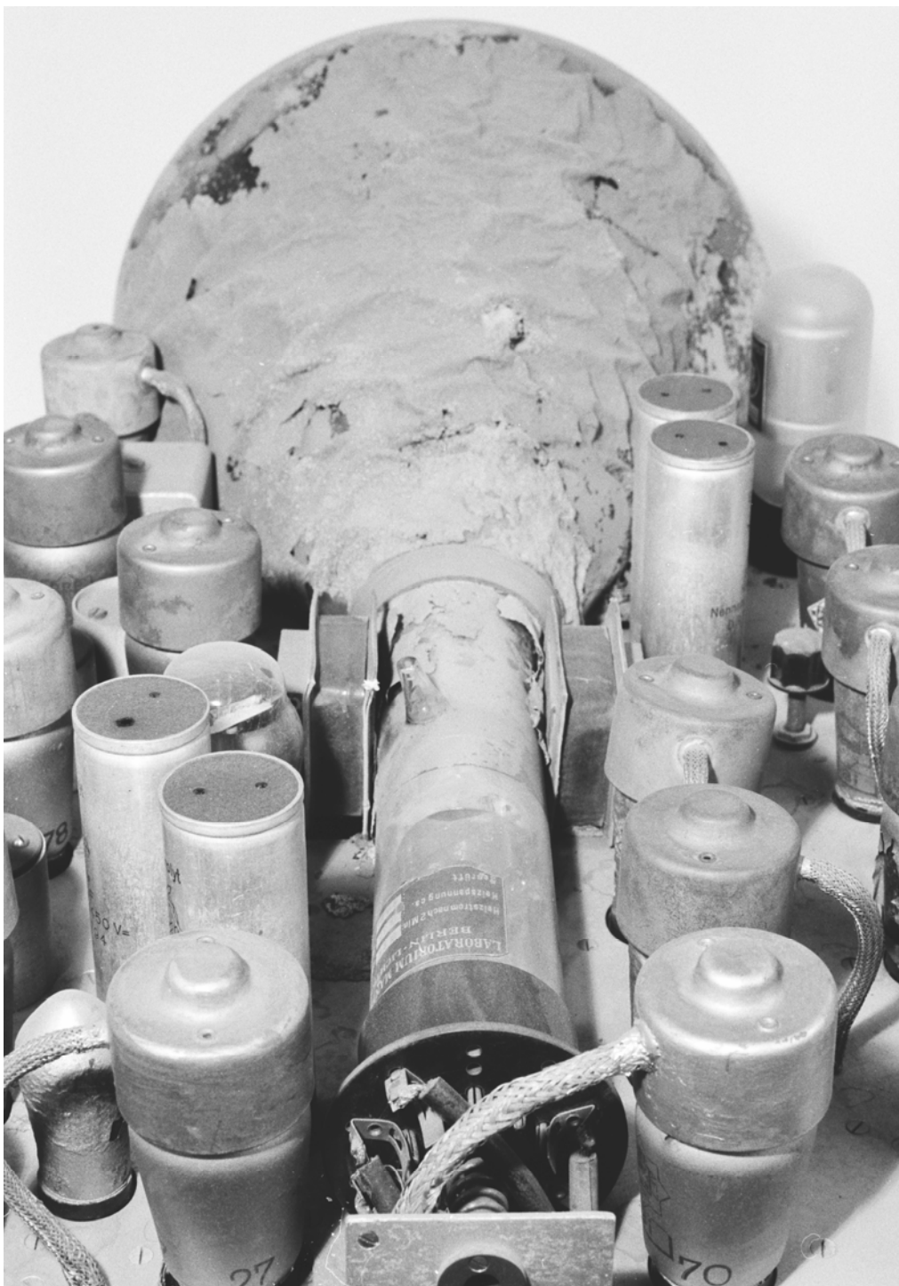
Fernsehempfänger Modell 36, Detail Bildröhre.
