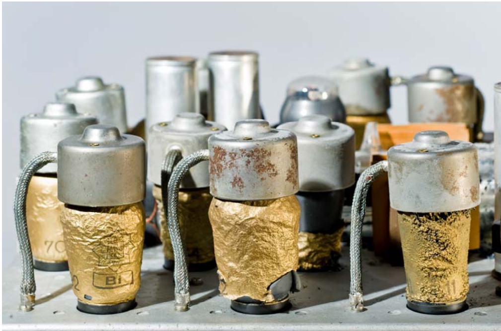
Fernsehempfänger Modell 36, Detail Elektronenröhren linke Seite.
