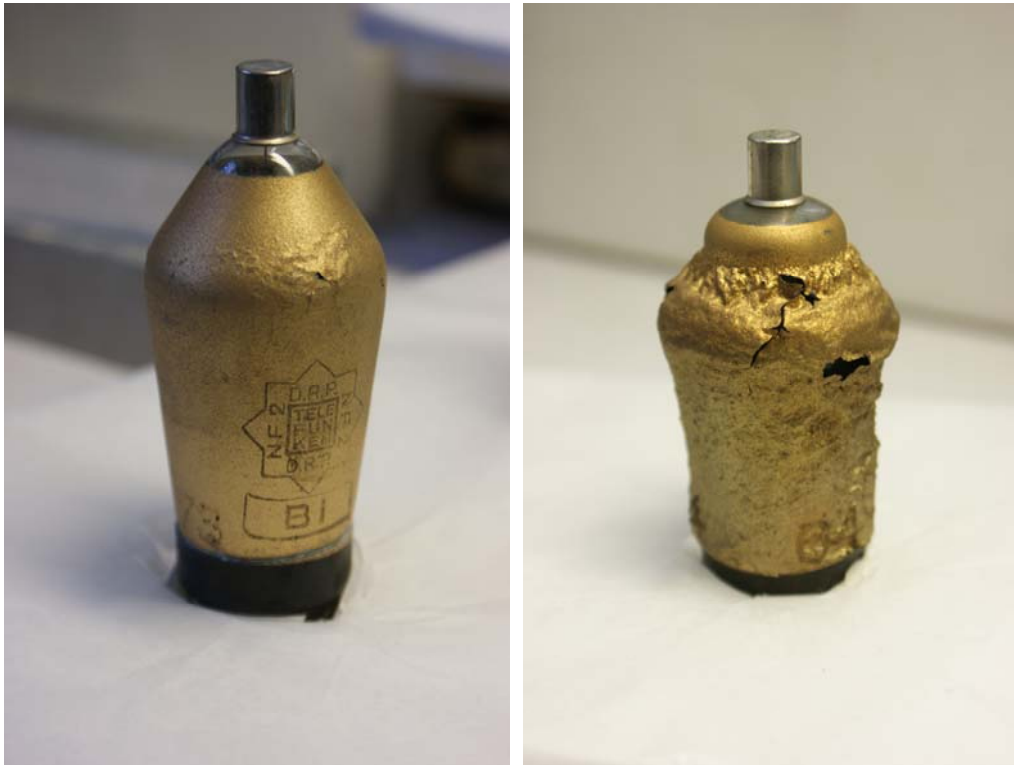
Abb. 33, 34: Die beiden für die Festigungstests verwendeten Elektronenröhren, Vorzustand.
