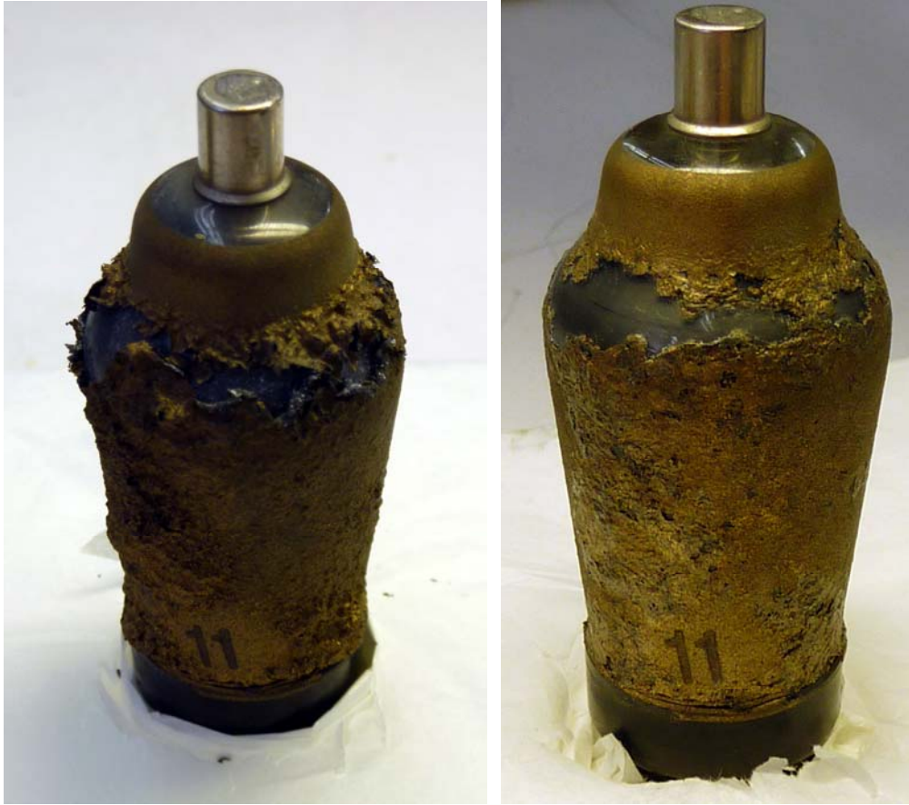
Abb. 37, 38: Elektronenröhre (3); links vor der Festigung, rechts nach der Festigung.
