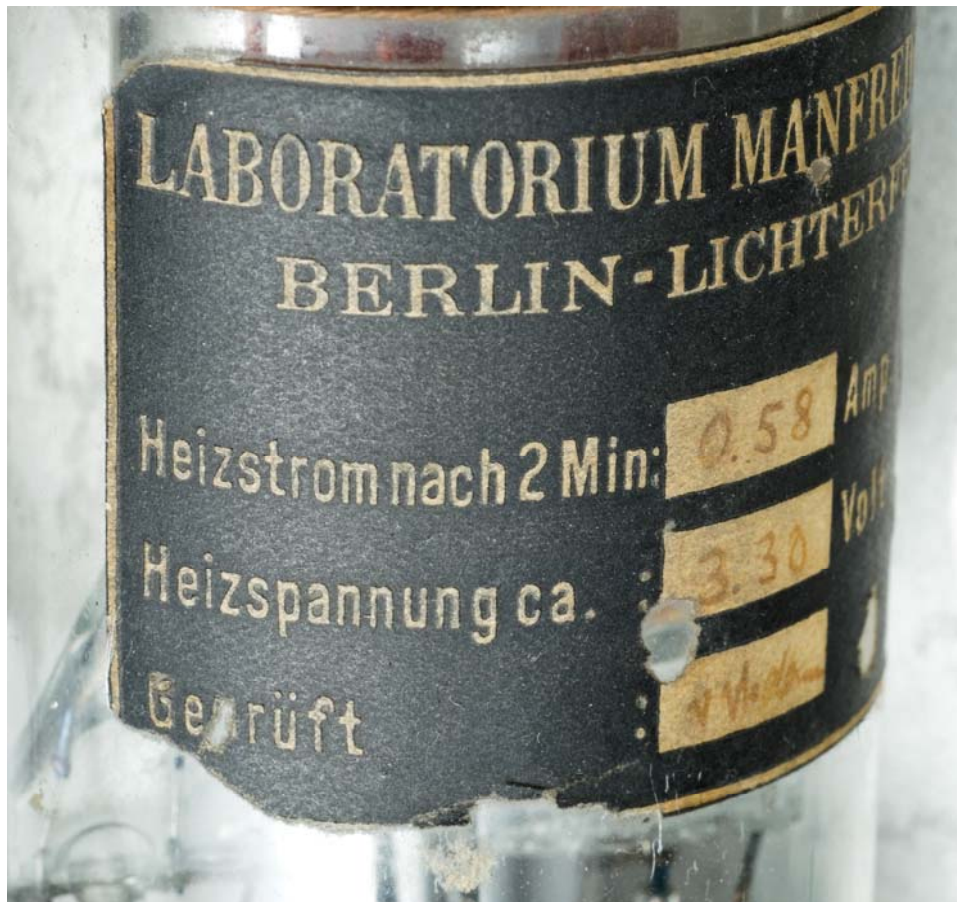
Abb. 15: Schild des Herstellers auf dem Bildröhrenhals [Foto: H. CZECH, DM].
