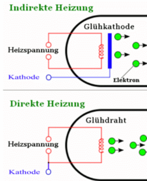
Abb. 16: Schematische Darstellung einer Elektronenröhre; [ http://upload.wikimedia.org/wikipedia/de/8/8b/Heizungsarten_e-roehren.gif ].
