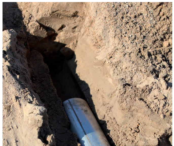
Abb. 24: Entnahme mit einem in die ungestörte geologische Schichtung eingeschlagenen Metallrohr, Situation bei Licht nachgestellt.
