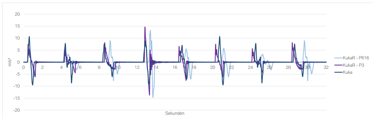
Abbildung 88 – TCP-Beschleunigung des nativ und extern gesteuerten Kuka-Roboters
