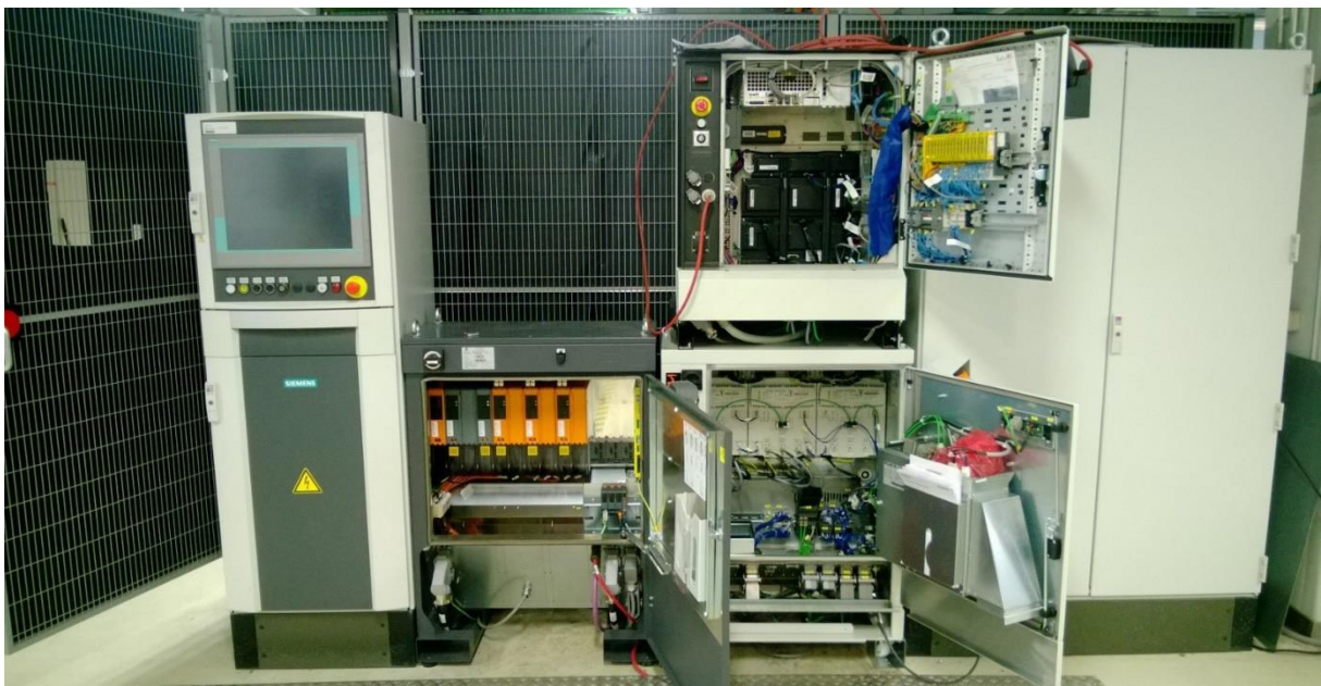
Abbildung 72 – Steuerungstechnik der Testzelle mit Comau- (u. l.), ABB- (o. r.) und Kuka-Steuerung (u. r.)
