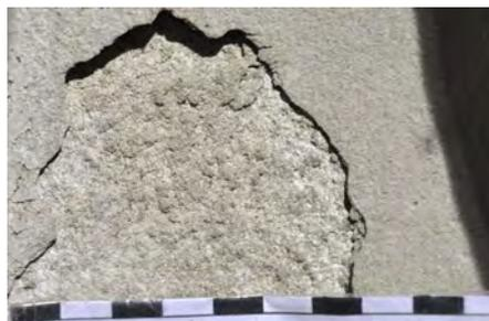
Abb. 306: Herausgebrochene Schale im Hintergrund.
