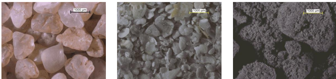
Abbildung 86: Mikroskopische Aufnahmen eines quarzitischen (links), karbonatischen (Mitte) und basaltischen (rechts) Sandes, aus ALTUHAFI & COOP (2011a)
