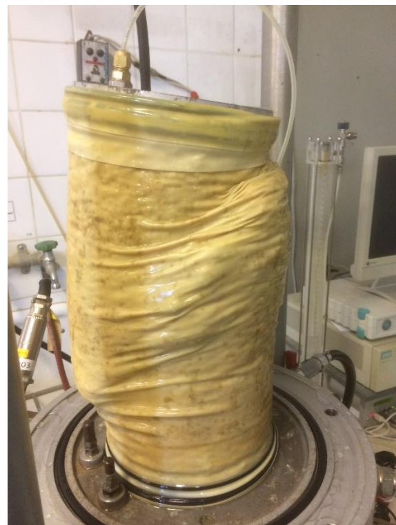
Abbildung 119: Probekörper des RC B 0/32 mit lokaler Bruchfuge nach Durchführung eines Triaxialversuches; Foto: Johannes Riedelsheimer
