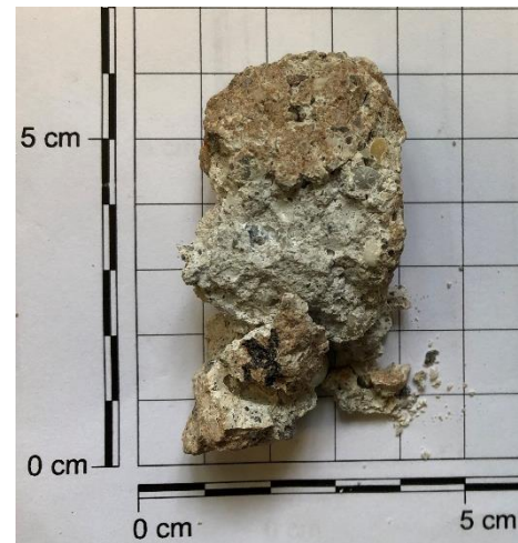
Abbildung 111: Einzelkorn aus Mörtel beim RC Mix 0/32 nach 30 Frost-Tau-Wechseln
