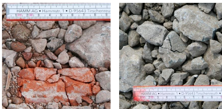
Abbildung 148: Infolge der Verdichtung (Vibration) gebrochenes Ziegelkorn (RC M 0/45-3) und Korn aus Granit (RC GS 0/45)
