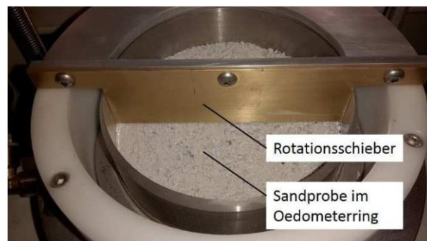
Abbildung 125: Einbau der Proben bei mitteldichter und lockerer Lagerung mittels Rotationsschieber, aus SCHÜLEN (2016)
