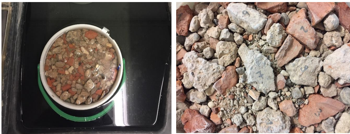
Abbildung 108: Sättigung des aufbereiteten Bauschuttgemisches (links) und Oberfläche nach der ersten Frostbeanspruchung
