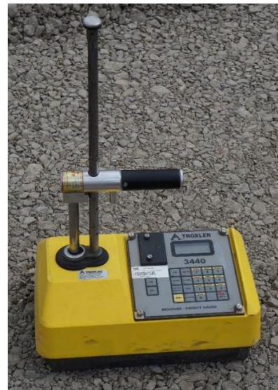
Abbildung 25: Beispiel einer Einstich- und Oberflächensonde zur Dichte- und Wassergehaltsbestimmung – Radiometrische Sonde „Troxler 3440“
