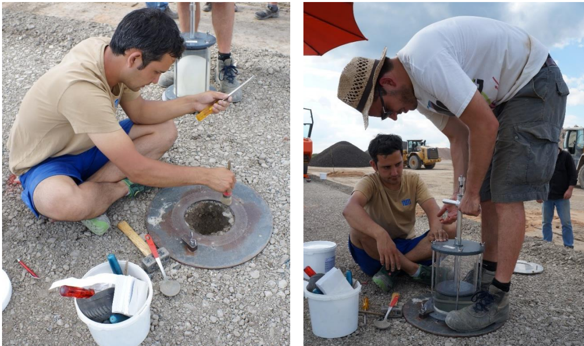
Abbildung 23: Aushub der Prüfgrube (links) und Ablesung an der Skalierung der Kolbenstange (rechts) bei der Dichtebestimmung mit dem Ballonverfahren
