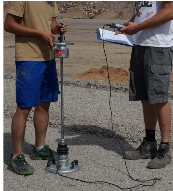
Abbildung 33: Links: Komponenten des leichten Fallgewichtsgerätes, adaptiert nach ADAM, KOPF & ADAM (2004); rechts: Durchführung eines dynamischen Plattendruckversuches
