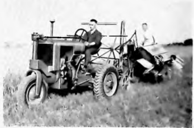
Die Leistung ist ausreichend für luftbereifte Zapfwellenbinder bis 7 Fuß und Pferdebinde bis 6 Fuß in ebenem Gelände. Die Zapfwelle liegt Mitte Hinterachse.
