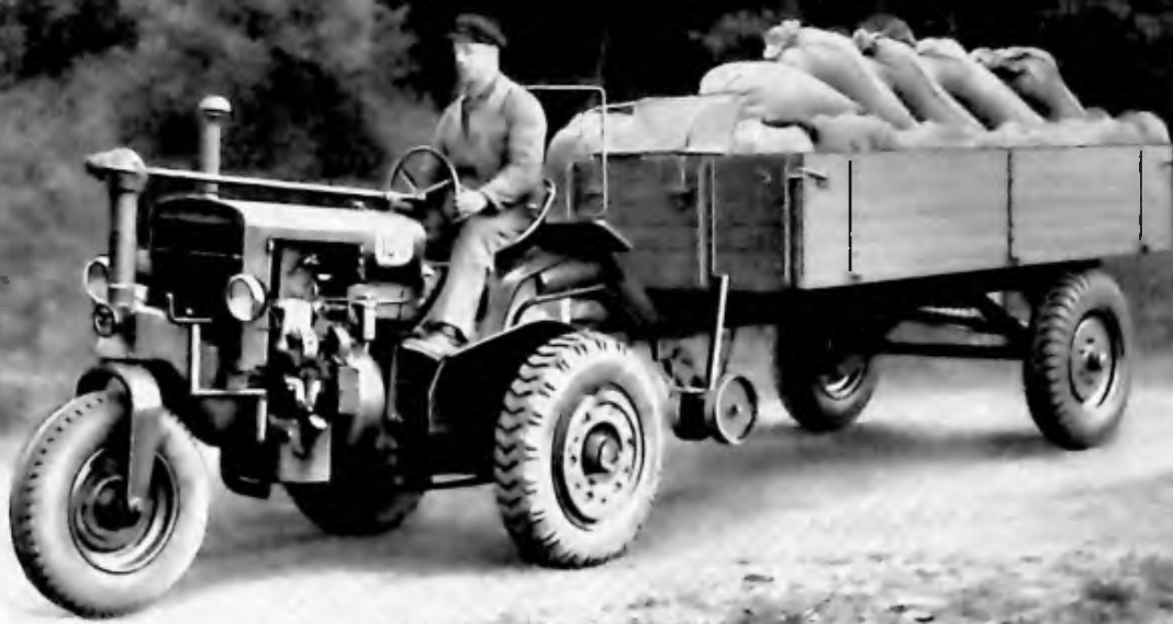
Als Straßenschlepper beträgt die Geschwindigkeit 12 km. Zugleistung auf ebener, griffiger Straße etwa 9 t. Mit Spezialsattelanhänger glänzend geeignet für losen Acker und schlechte Wege, zum Abfahren von Kartoffeln, Rüben, Getreide usw.
