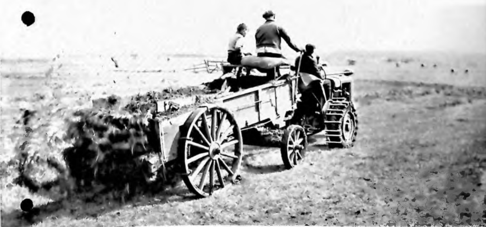
Ein ideales Gespann für den Bauern ist der MTW mit Stalldüngerstreuer. Die Verteilung ist hervorragend bis doppelte Wagenbreite, sogar bei halblangem Dünger.
