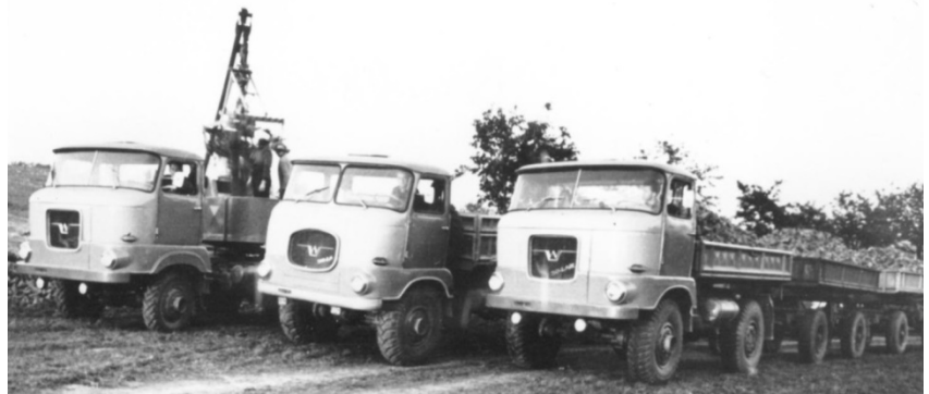
Bild 1: Erste Muster des LKW W 50 (Entwickelt und gebaut in Werdau, 5 t Nutzmasse
