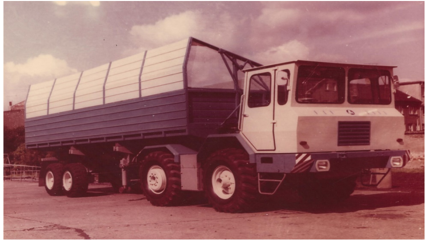
Bild 7: Zugmittel ZM 1800 4x4 im Traktorenwerk Schönebeck entwickelt und gebaut mit Einseitenkippaufleger HLS 130.11 - entwickelt und gebaut in Meißen (1972)
