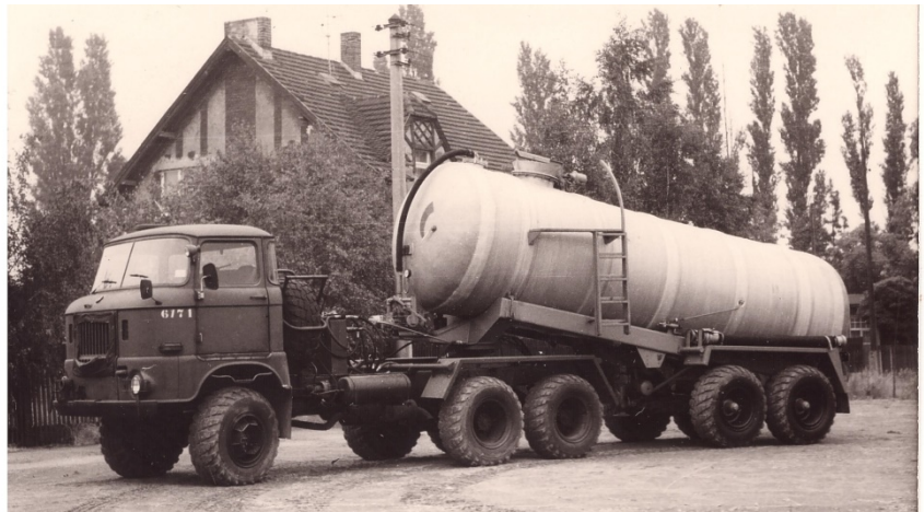
Bild 8: L 60 6x6 (entwickelt und gebaut in Ludwigsfelde) mit Gülletanksattelaufleger HLS 130.27 entwickelt und gebaut im Fahrzeugwerk Annaburg
