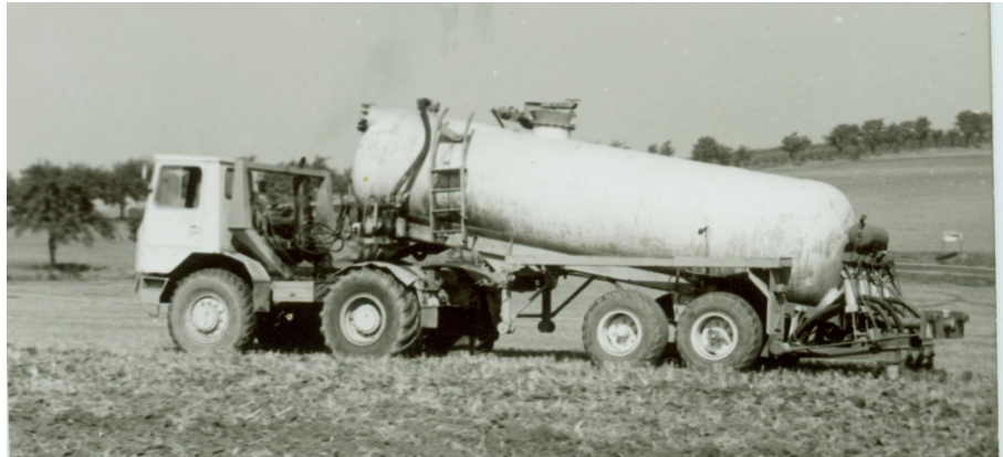
Bild 12: Zugmittel G116 aus Ungarn mit Güllesattelauflieger vom Fahrzeugwerk Annaburg, in Meißen ausgerüstet mit Werkzeugen zur Einarbeitung in den Boden (Eigenentwicklung, 1972)
