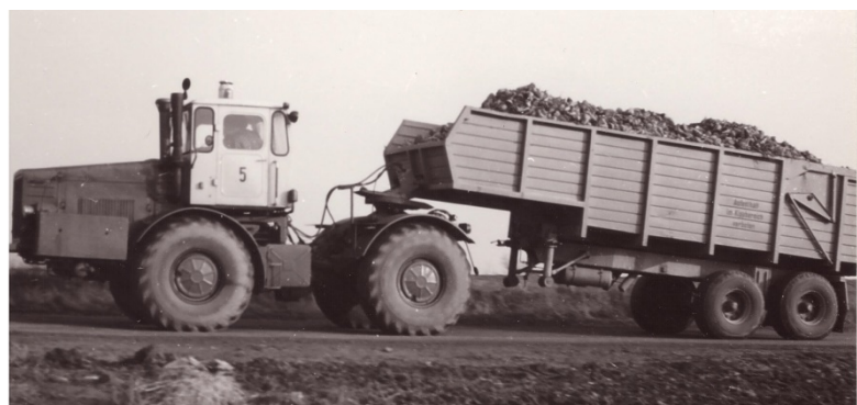
Bild 2: Erprobung des Traktor K 700 mit Hinterkipppauflieger HLS 130.12, in Meißen entwickelt und gebaut (1971)
