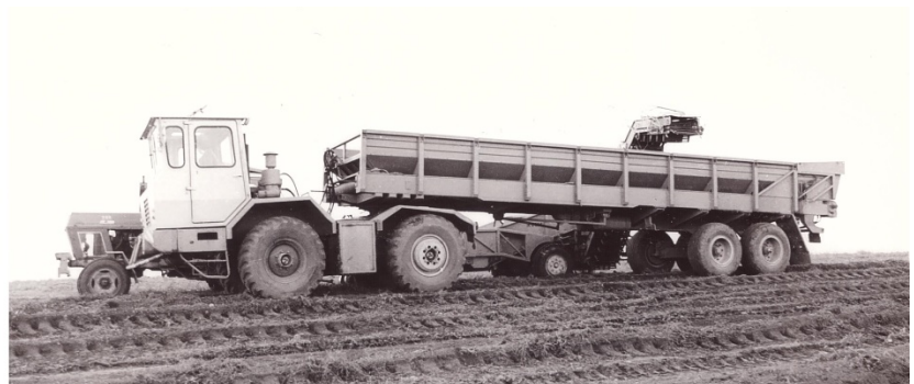
Bild 9: Zugmittel ZM 1800 mit Rollbodensattelaufleger HLS 130.04 entwickelt und gebaut in Meißen (1973), während der Kartoffelernte
