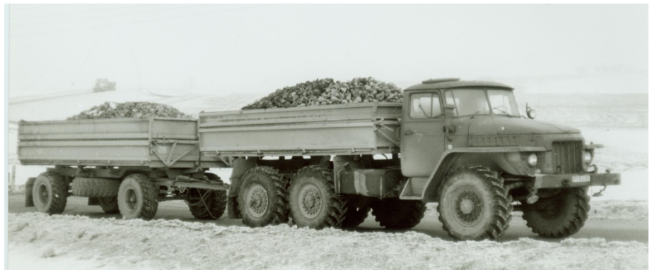
Bild 13: LKW URAL 6x6 mit Kipppritsche des HW 60.11 und DDR-Dieselmotor sowie angehängtem Anhänger HW 80.11, umgerüstet in Meißen, in Vorbereitung einer vorgesehenen Abrüstung (1979)
