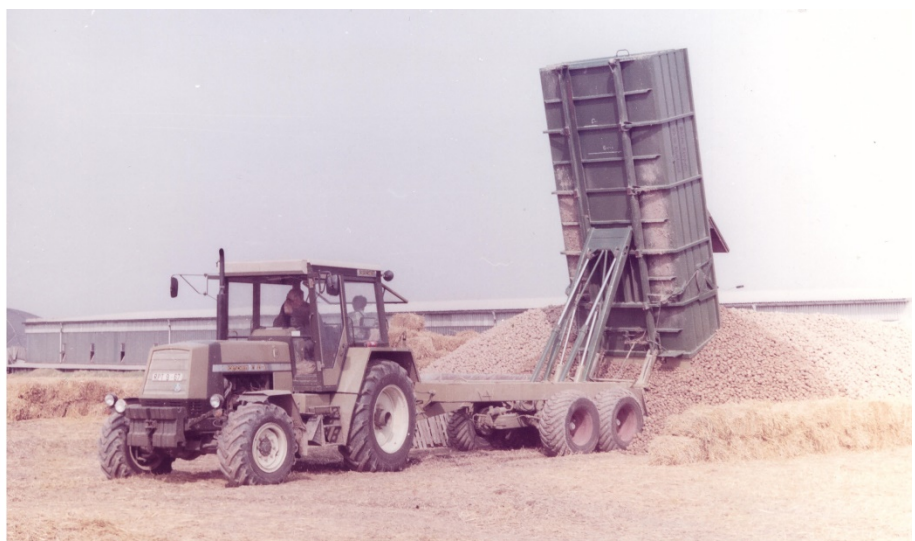
Bild 14: ZT 323 mit Halbhochkipper HTS 100.14 zum direkten Schütten ca. 3m hohen Feldrandmieten während der Rübenenernte, mit gefederter Deichsel, entwickelt und gebaut in Meißen (1986)
