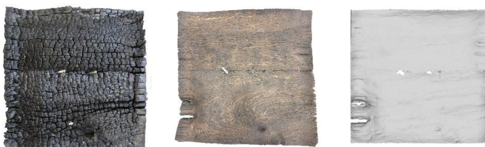
Bild 3 Prüfkörper Vollholz Eiche (v.l.n.r.) Holzkohleschicht, gebürstet, 3D-Scan
