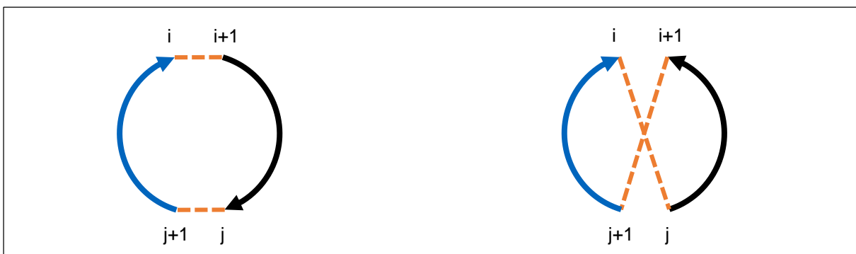
Abbildung 3-5: Schematische Funktionsweise eines 2-opt Austausches (vgl. [Psa-1983])
