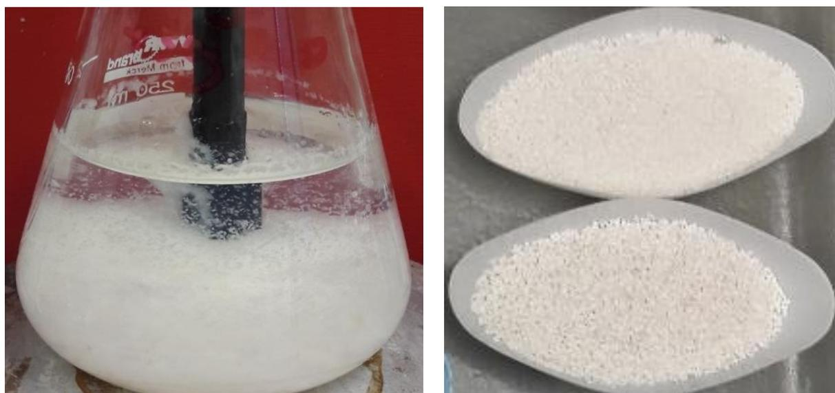
**Abbildung 42:** Links: Titration bis zur vollständigen Ladungsneutralisation des CaATBS-co-NNDMA mit AM/MAPTAC = 60/40, optisch verfolgt. Rechts: getrockneter und fraktionierter Polyelektrolytkomplex.
