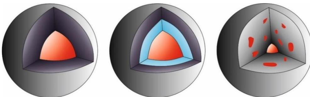
**Abbildung 22:** Mono- und polynuklide Mikrokapseln; (a) mononuklides Core-Shell-Partikel, (b) mononuklides Core-Shell-Partikel mit mehreren Beschichtungen; (c) polynuklides Core-Shell-Partikel (nach [188]).
