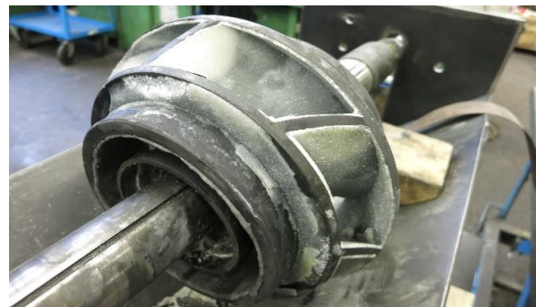
Abbildung 6: Carbonatische Ablagerungen an der Impellerstufe einer Tauchkreiselpumpe aus einer Geothermieanlage im Molassebecken.
