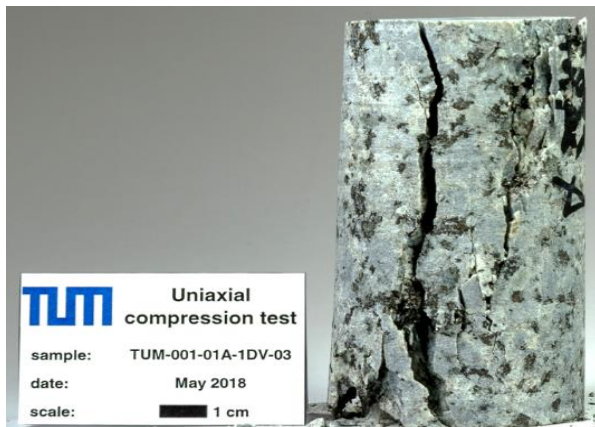
Abbildung 12: Granit-Analogprobe nach der Durchführung eines uniaxialen Kompressionstests zur Parametrisierung des Bruchverhaltens im Labor.
