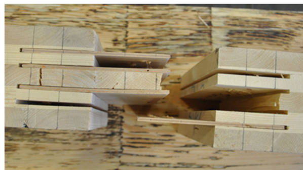
Abbildung 6.63: a) Bruchlasten und charakteristische Tragfähigkeiten Zug, b) Versagensbild
