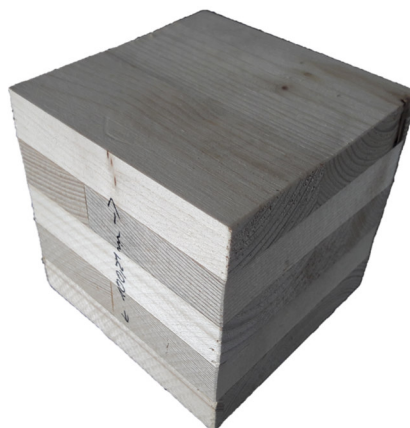
Abbildung 6.6: Aufbau fünflagiges Brettsperrholz, Probenwürfel nach Darrmethode
