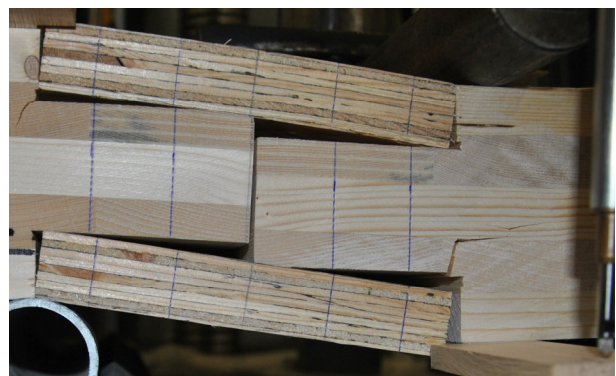
Abbildung 6.58: a) Bruchlasten und charakteristische Tragfähigkeit Plattenschub, b) Bruchbild
