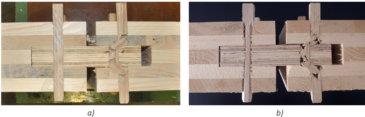
Abbildung 6.28: typische Bruchbilder der Eichennägel in Verbindung 1, a) x- und b) y-Schnittufer
