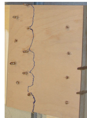
Abbildung 6.67: a) Bruchlasten und charakteristische Tragfähigkeiten bei Scheibenschub, b) Bruchbilder
