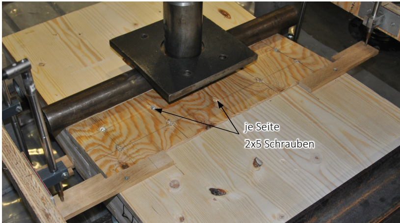
Abbildung 6.55: Verbindungsmittelbereich Verbindung 2 für Plattenschubversuche
