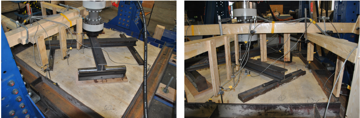
Abbildung 7.8: Prüfkörper Schalensegmentversuche im Portal
