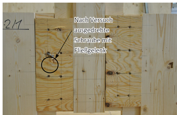
Abbildung 6.50: a) Bruchlasten und charakteristische Tragfähigkeiten Schub in der Ebene, b) Versagensbild
