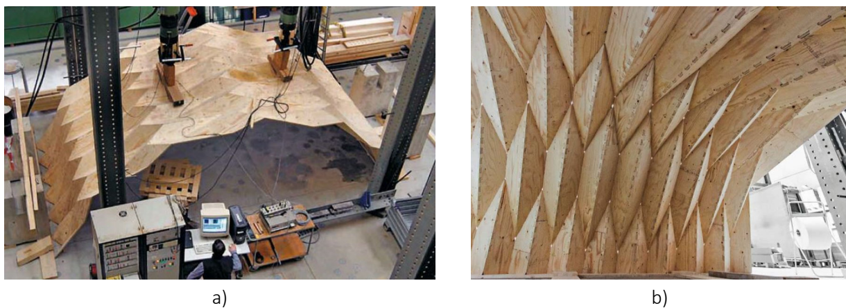
Abbildung 2.12: a) Falterwerk als Zylindergewölbe und b) mit zusätzlicher Längskrümmung (beide [Robeller und Weinand 2016])
