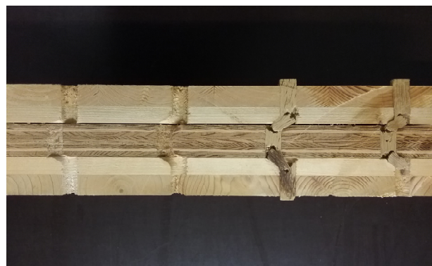
Abbildung 6.33: a) Bruchlasten und charakteristische Tragfähigkeiten Schub in der Ebene, b) Bruchbild
