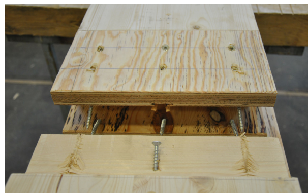
Abbildung 6.46: a) Bruchlasten und charakteristische Tragfähigkeiten Zug, b) Versagensbild
