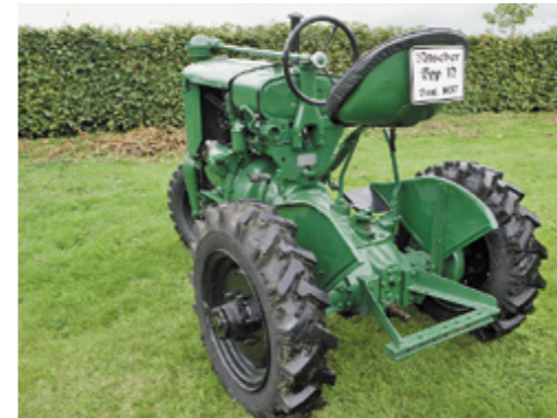
Die Anhängerkupplung des Ritscher MTW-N befindet sich vor (!) der Hinterachse. Das soll ein Aufbäumen verhindern, schränkte den Wendekreis mit Anhänger aber ein.
