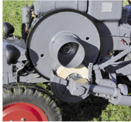
Der Fendt verfügte über einen Reibradantrieb für das Mähwerk. Gelobt wurde daran das dosierte Anfahren, kritisiert der fehlende Kraftschluss bei feuchten Bedingungen.
