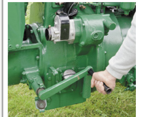
Der Ritscher MTW-N wird mit Benzin angelassen. Die Kurbel überträgt die Drehung per Kegelrad auf das Schwungrad des Kämpfer-Dieselmotors.
