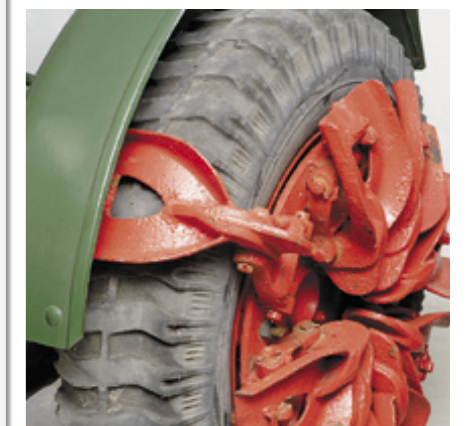
Klappgreifer waren wichtig, um die Zugkraft des 1400 kg leichten 11er Deutz auf rutschigen Böden zu erhöhen.
