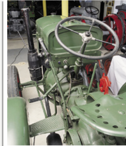
Der 11er Deutz hat kein Fußgas, sondern eine Kurbel für das Handgas. Das Kuppelungspedal ist waagrecht angelenkt.
