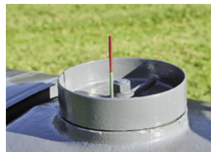
Etwa 35 Liter fasst der Vorrat des Verdampferkühlers vom Fendt-Dieselross. Wenn der grüne Teil des Anzeigestabs versunken ist, muss Wasser nachgefüllt werden.
