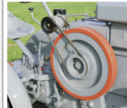
Die Lichtanlage für den AS 2 von Sendling kostete 1937 einen Aufpreis von 120 Reichsmark. Dazu gehörte auch die frei liegende Lichtmaschine.
