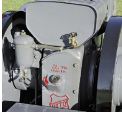
Das Fendt-Dieselross hat einen Deutz-Motor. Gelobt wurde die Wendigkeit, kritisiert die fehlende Differenzialsperre. Ein damals sehr wichtiges Bauteil war der Kraftstofffilter.
