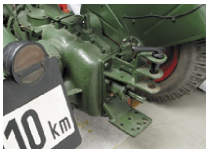
Die Zapfwelle war beim 11er Deutz eine Sonderausrüstung. Sie war damals wichtig für den Antrieb des Mähbinders, sonst gab es kaum angetriebene Geräte.
