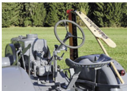
Vor 70 Jahren war das Fendt-Dieselross ein außerordentlich moderner Arbeitsplatz. Mit dem langen Hebel am rechten Kotflügel hebt der Fahrer das Mähwerk aus.
