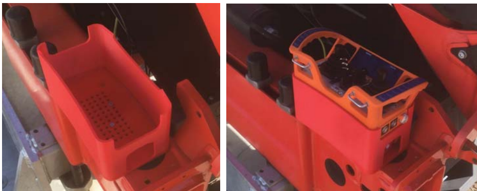
Abbildung 5-8: Box zur Referenzierung der Funksteuerung im Bezug auf das Krankoordinatensystem
