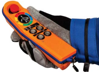
Abbildung 2-6: HBC-pilot zur Einhandsteuerung von Kranen und Maschinen [HBC-2019a]
