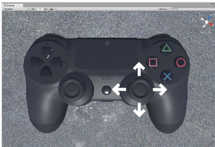
Abbildung 4-14: Die virtuelle Entsprechung des real gehaltenen Controllers inkl. Veranschaulichung der Bewegungsrichtungen am rechten Joystick.
