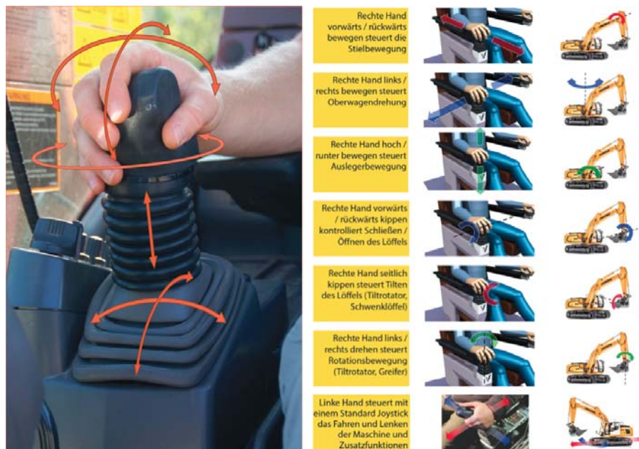
Abbildung 2-8: uniGRIP System mit 6 Freiheitsgraden [Vem-2019b]
