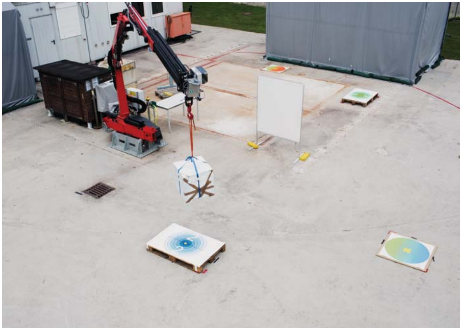
Abbildung 6-1: Demonstratoraufbau mit Zielpositionen (im Bild Position 2, blau und Position 3, grün) der Last und jeweiliger Startposition der Bediener, wie in der Evaluation genutzt.
