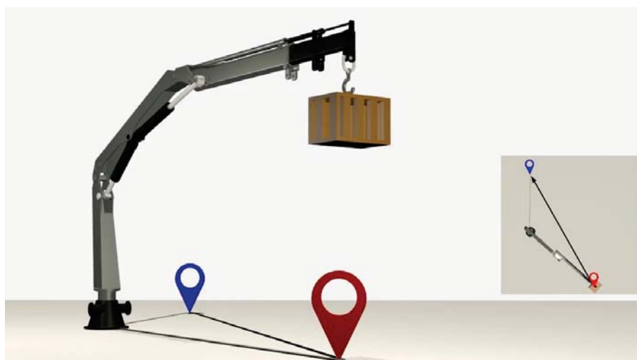
Abbildung 4-8: Screenshot aus einem der Animationsvideos. Konkret wird Bewegung 3 aus Position 4 dargestellt (vgl. Abbildung 4-7). Von der Startposition (roter Marker) sollte die Last ca. in einem 120 deg Winkel zur Zielposition (blauer Marker) bewegt werden. Unterstützend werden ein Pfeil am Boden sowie die Vogelperspektive der Bewegung gleichzeitig animiert angezeigt.
