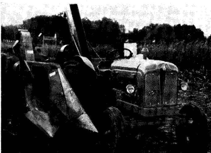
Abb. 4: Anbau-Picker von Dearborn (Ford) an der Dreipunktaufhängung eines normalen Schleppers angebaut. Die Maiskolben werden auf einen angehängten Wagen gefördert
