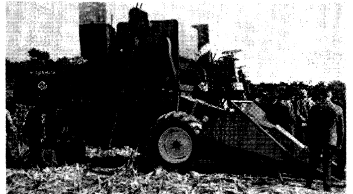
Abb. 5: Pflück-Drescher der International Harvester waren in vier verschiedenen Größen und Baumustern vertreten
