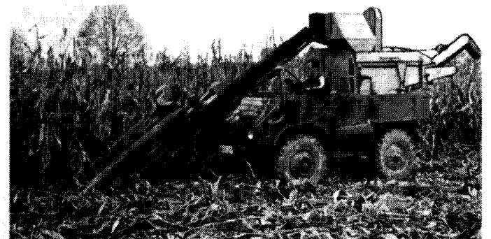
Abb. 8: Eine kompakte Spezial-Maschine für den Pflück-Drusch ist der Pflück-„Rebler“, am Unimog angebaut; das Pflückaggregat stellt Tröster-Butzbach her, den auf der Pritsche aufgebauten Rebler Gehringhoff, Ahlen
