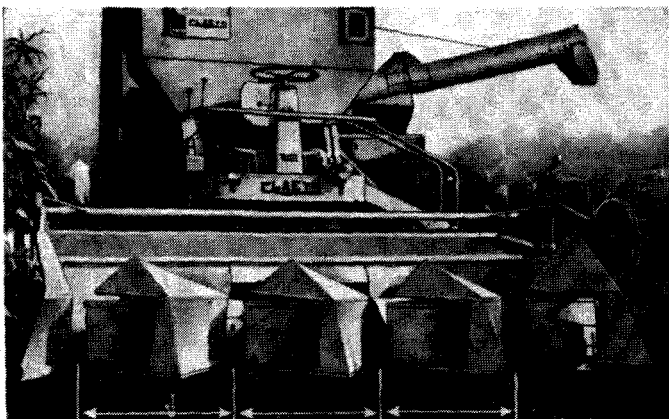
Abb. 11: Selbstfahrer-Mähdrescher (Claeys - Belgien) mit vierreihigem Mähvorsatz
