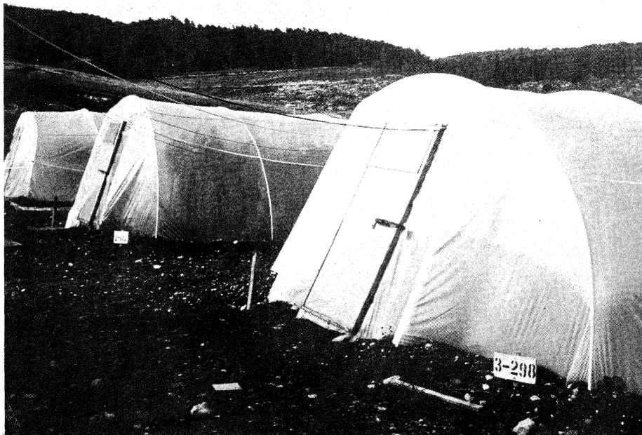
Abb. 17: Folien-Versuchsgewächshäuser der Fa. Ginegar mit unterschiedlicher Eindeckung
