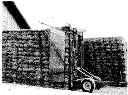
Abb. 12 : Absetzen des Ballenstapels beim New-Holland-system, hier Modell 1010. Die größeren Modelle drücken den Wagen hydraulisch unter dem Stapel weg.
