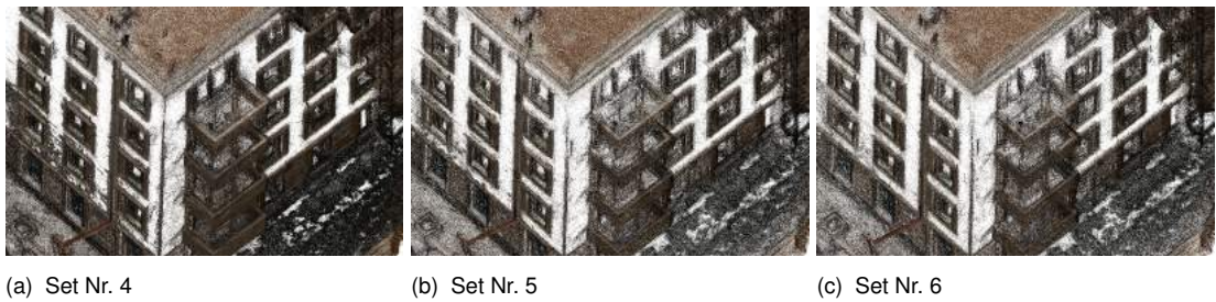
Abbildung 22 Detailansicht 2 des 2018er Datensets. Große, homogene Flächen können schwer bis gar nicht erfasst werden. Dahingegen werden die filigranen Balkonstrukturen zwar in allen Bildern detektiert, aber die Punktdichte ist stark abhängig von der Bildanzahl.
