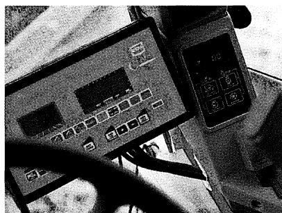
Im GPS-Empfänger werden u. a. die Koordinaten des Standortes und die Geschwindigkeit des Fahrzeuges ermittelt
