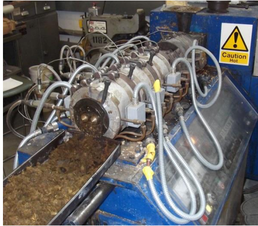
Abbildung 2.1 Gleichläufiger Doppelschneckenextruder des Wolfson Centre for Materials Processing bei der Extrusion von Weizenstroh mit 6 % (w/v) NaOH zur Isolierung von Hemicellulose. Technische Daten: Doppelschneckenextruder mit fünf Heizzonen, Länge: 800 mm, Durchmesser der Schrauben: 35 mm.
