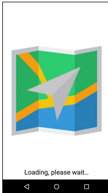
Abbildung 51: SplashScreenActivity: diese Aktivität wird aufgerufen, wenn die Applikation gestartet wird. Wenn GPS bei Applikationsstart aktiviert ist, wird die aktuelle Position in der Datenbank abgespeichert.
