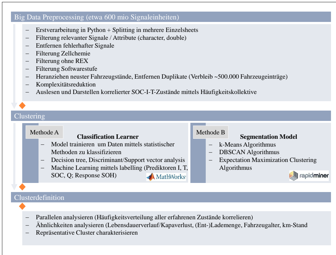
Abbildung 3.5: Schematische Darstellung der Data Mining and Analytics Vorgehensweise bestehend aus Preprocessing, Clustering und Clusterdefinition.
