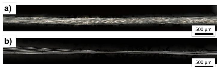
Abbildung 4.10: W-Garn: 15 W-Fasern ( $16\ \mu\text{m}$  Durchmesser); Konfokales Laser-Scanning-Mikroskop Bilder
