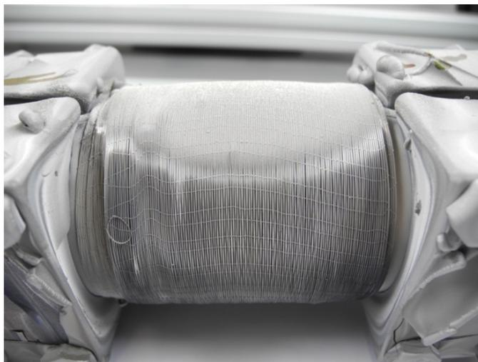
Abbildung 6.6: In FRED hergestelltes  $W_f/W$  auf dem Heizrohr. Es wurde nur an der Oberseite Wolfram abgeschieden.
