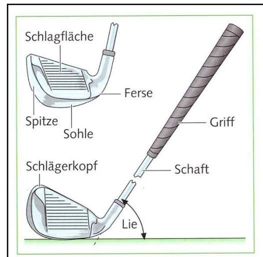
Abb. 5. Bestandteile eines Golfschlägers (Hamster, 2005, S.37)
