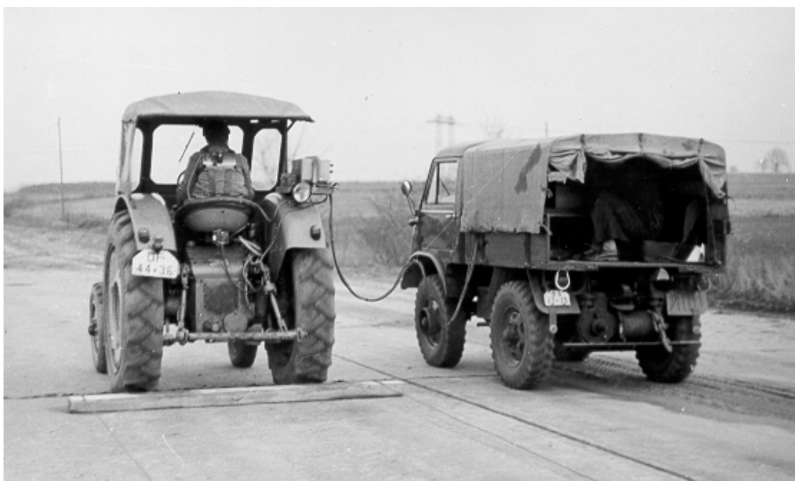
Bild 4: Messungen zur Schwingungsbelastung von Schlepperfahrern
