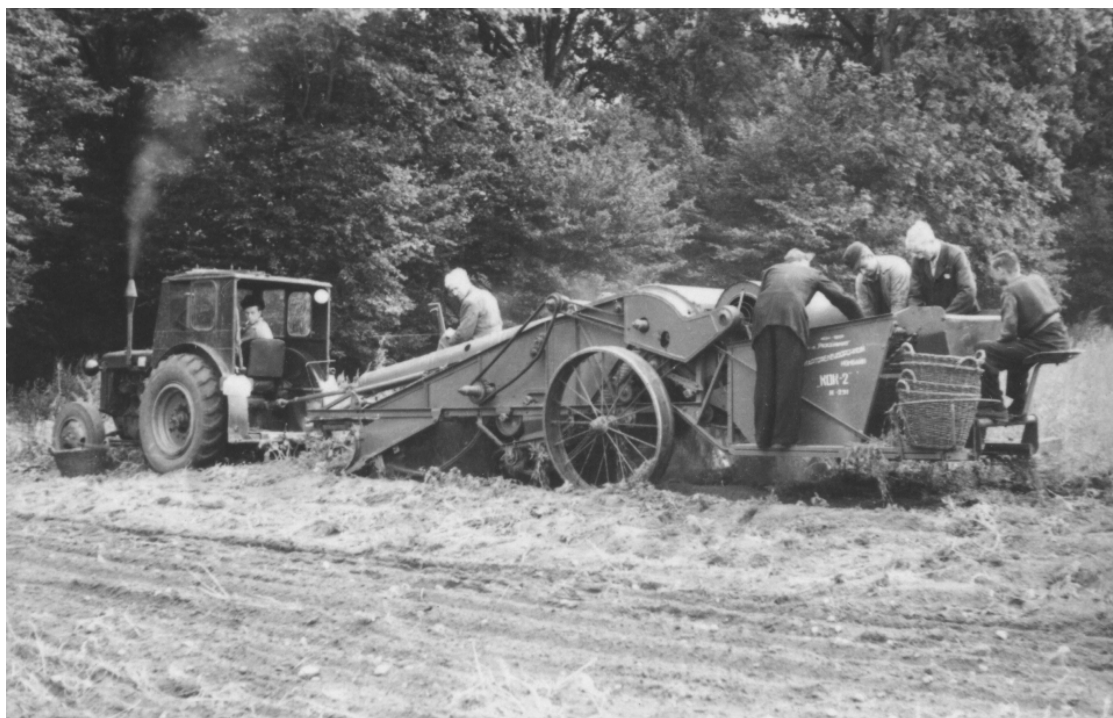
Bild 1: Ersterprobung der zweireihigen Kartoffelkombine KOK 2 aus der UdSSR in Potsdam-Bornim: Das Erntegut wurde in Körben abgefüllt getragen.
