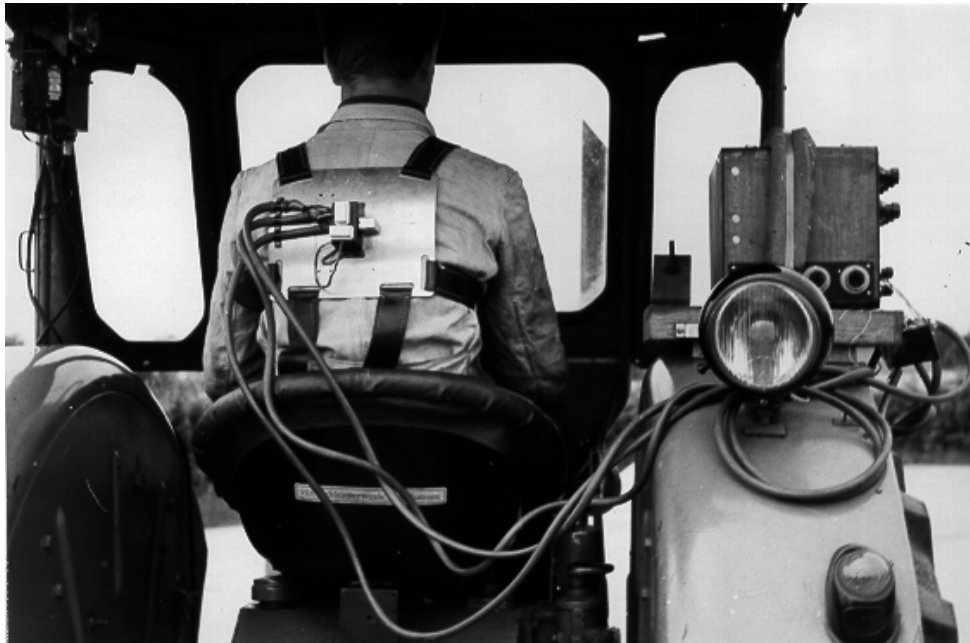
Bild 3: Eigenentwickelte Beschleunigungsmesser und Transistormessverstärker bei Traktorensitzuntersuchungen, um die Auswirkungen der Traktorschwingungen auf die Wirbelsäule von Traktoristen feststellen zu können
