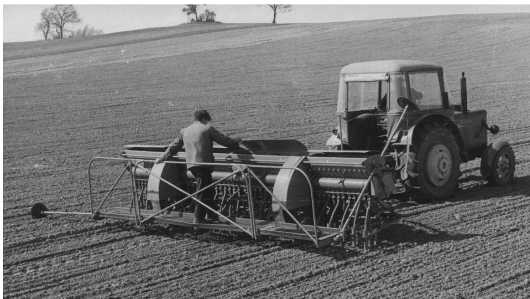
Bild 1: Drillmaschine A 591 mit 5 m Arbeitsbreite
