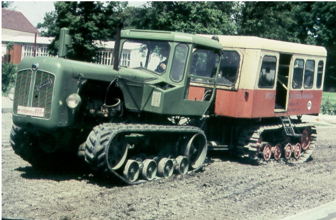
Bild 5: Dederonverstärkte Gummigleisbänder am 60-PS-Kettenschlepper KS-30 des Brandenburger Traktorenwerks bei Zugkraftmessungen auf der Tonbahn
