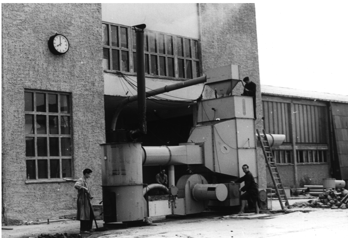
Bild 1: Prüfung des Körnertrockners K 844 (Petkus Wutha) vor der neuen Rinderstallanlage des Bornimer Instituts
