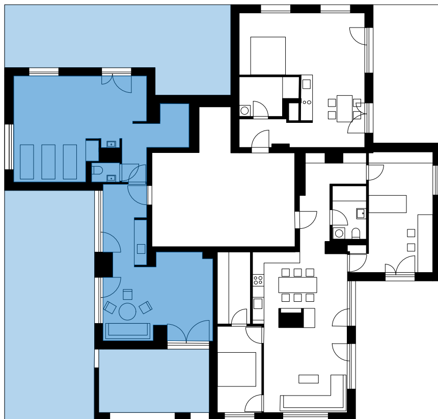
Abbildung 2-11 Grundriss gemeinschaftliches Wohnen am Beispiel Seestern Aspern DG, eigene Darstellung auf Grundlage zur Verfügung gestellter Entwurfspläne im Maßstab 1:200 des Architekturbüros einszueins Architektur
