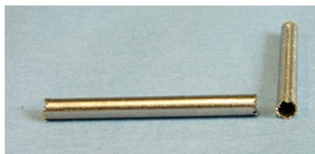
Abbildung 31: Bohrröhrchen aus Stahl (Innendurchmesser 5 mm) mit gezackten Enden.
