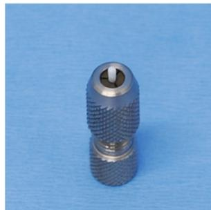
Abbildung 48: Poröser Zylinderindenter aus Glas ( $d = 1,5 \text{ mm}$  (SA  $0,2 \text{ mm}$ ); Porengröße:  $16\text{-}40 \text{ }\mu\text{m}$ ; Porosität  $50 \%$ ).
