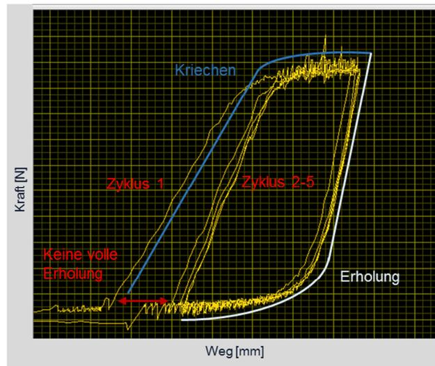
Abbildung 72: Beispielhaftes Kraft-Weg-Diagramm des quasistatischen zyklischen Indentationsversuchs. Im 1. Zyklus konnte der Knorpel seine Ausgangshöhe nicht wieder erreichen. Im 2.-5. Zyklus war die Höhe des Kriechverhaltens und der Erholung annähernd gleich. Weiterhin ist der unterschiedliche Kurvenverlauf der Erholung und des Kriechverhaltens ersichtlich.
