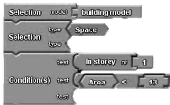
**Abbildung 4.11:** Beispielhafte BIMcraft Anfrage zur Selektion von Räumen, (Wülfing et al., 2015)
