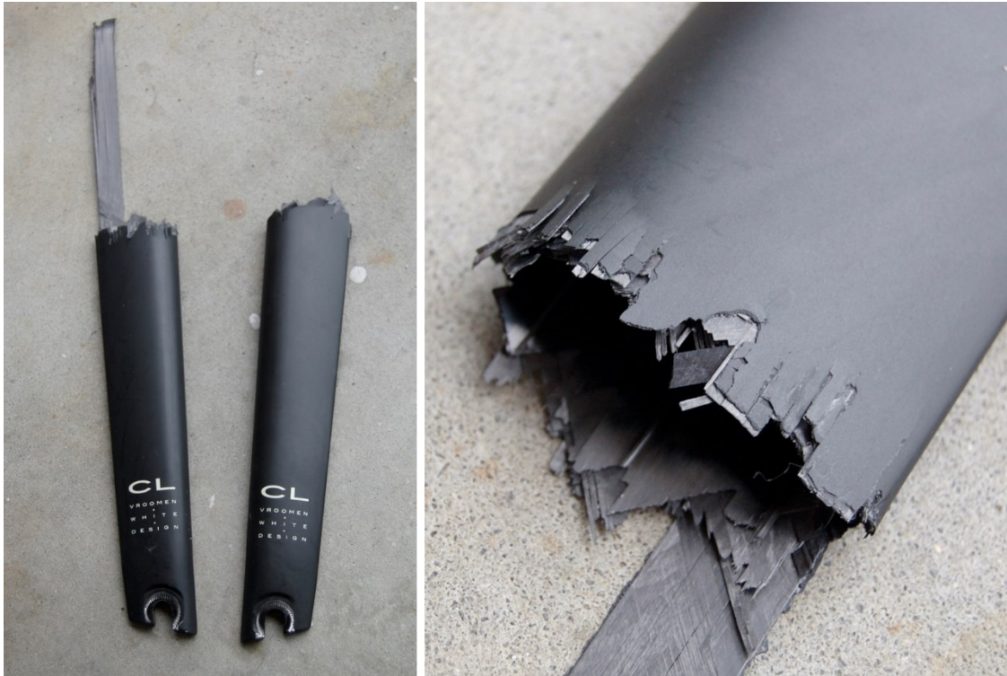
Fig. 1-1: Broken Cervelo C2P Fork [2]
