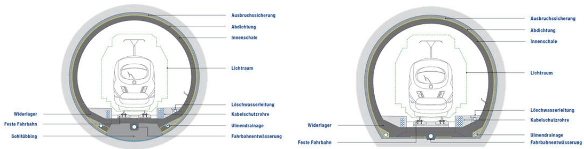
**Abbildung 10: Schematische Darstellung der Regelquerschnitte des BBT für den maschinellen Vortrieb (links) und den konventionellen Vortrieb (rechts) [Gall]**
