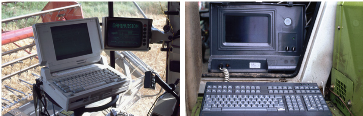
Bild 1: COMPAQ SL 286 mit 20 MB Harddisc und RS 232 Schnittstelle (links) [6] und TELEFUNKEN Robust PC 386 mit 40 MB Harddisc, RS 232 und RS 485 Schnittstellen(rechts) [7]
