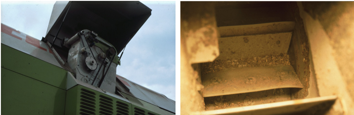
Bild 3: Anordnung des Claas Yield-O-Meter im Körnerelevator oben (links) [13] und Kammer des Zellenrades (rechts) [14]
