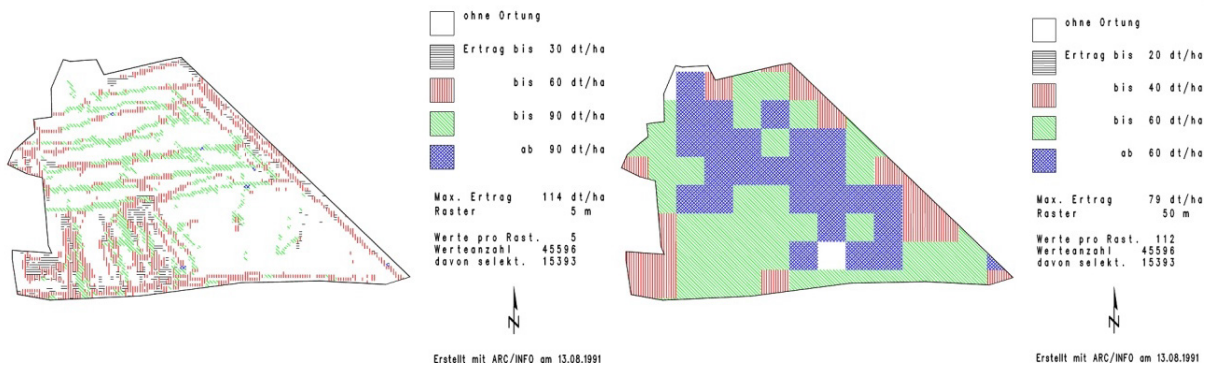
Bild 4: Ertragskarten Flachfeld Scheyern 1990, 17,7 ha, Winterweizen, Durchflussmesser „Daniavision“, 12. Aug. 1990, Rastergröße 5 m (links) [16] und 50 m (rechts) [17]
