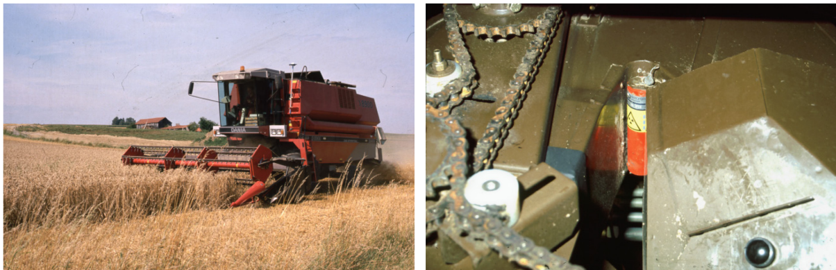
Bild 2: Mähdrescher CASE INTERNATIONAL „D 8900 DANIA“ mit GPS-Antenne (links) [8] und installierter radiometrischer Ertragsmessung(rechts) [9]
