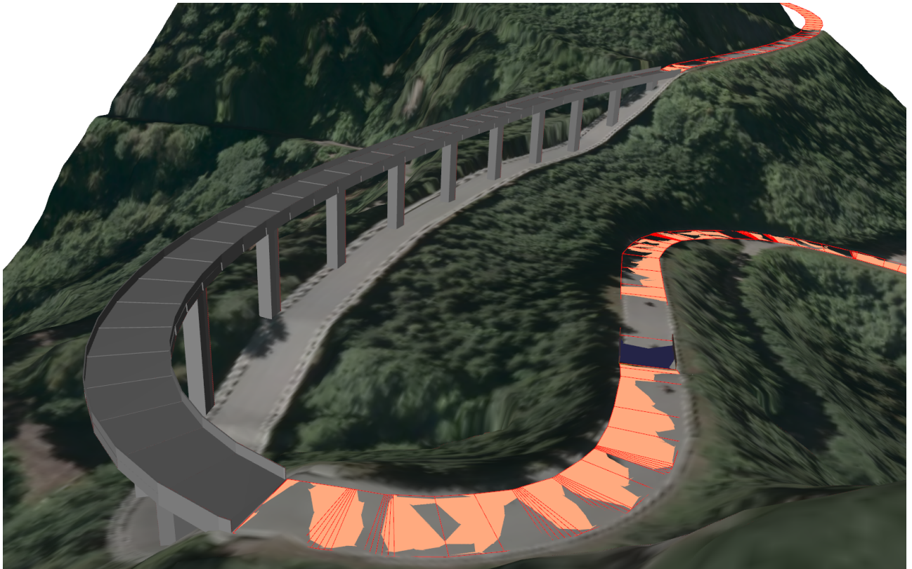
(a) Korrigiertes und texturiertes DGM ohne Brückenkörper jedoch mit Brückenmodellen sowie Straßenflächen
