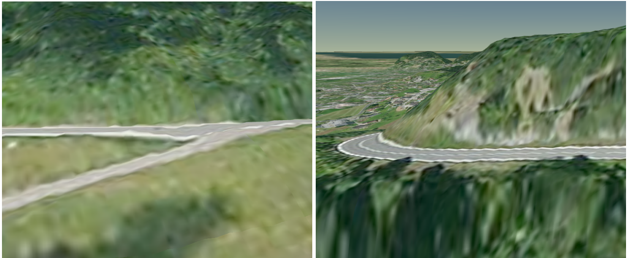
(a) Fehlerhafte Korrektur im Kreuzungsbereich
