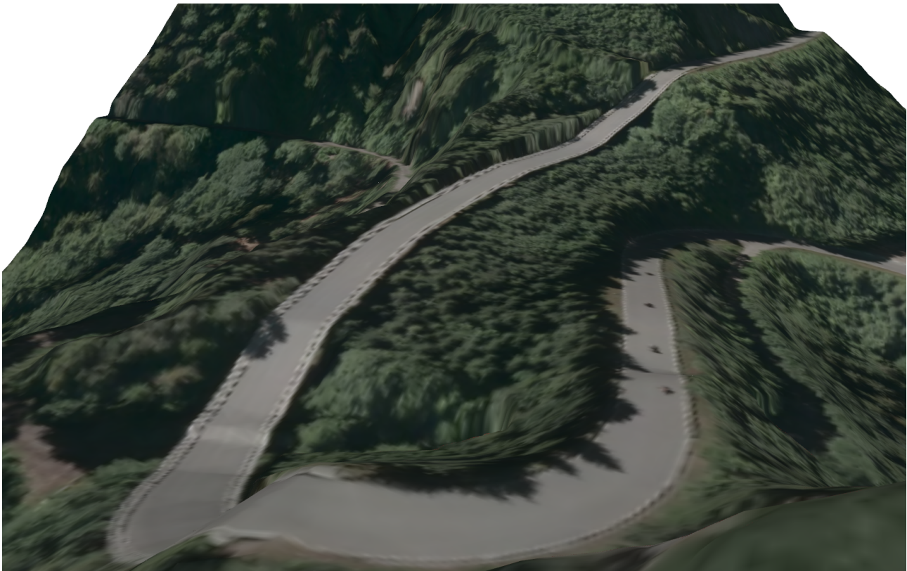
(b) Korrigiertes und texturiertes DGM ohne Brückenkörper
