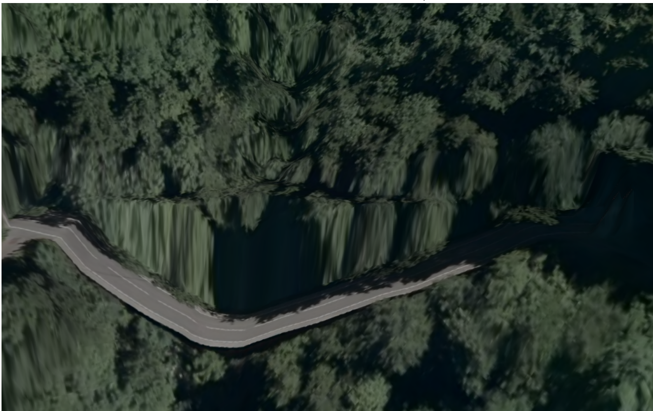
(b) Korrigiertes und texturiertes DGM ohne Brückenkörper
