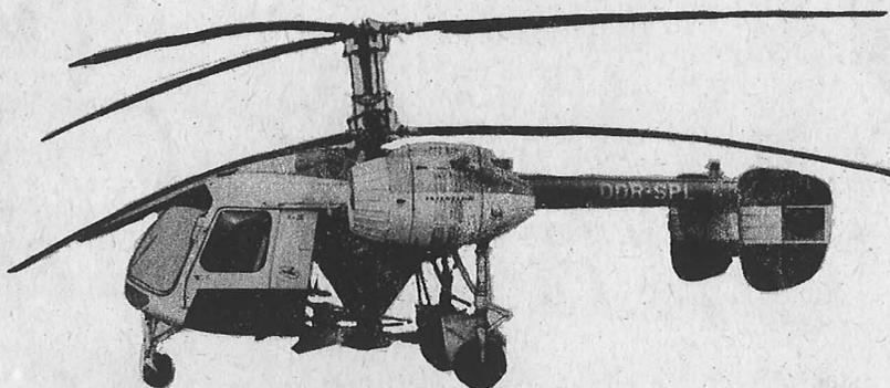
Schleuderradstreuanlage des Mehrzweckhubschraubers Ka 26
