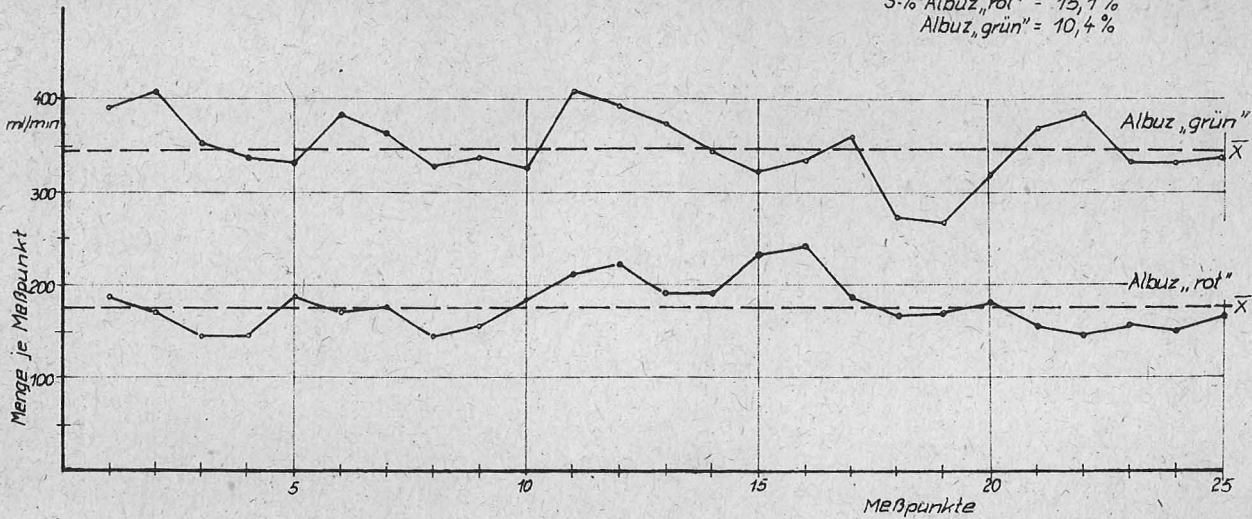
Abb.3 Querverteilung der Schlitzdüsen im Düsenverband
