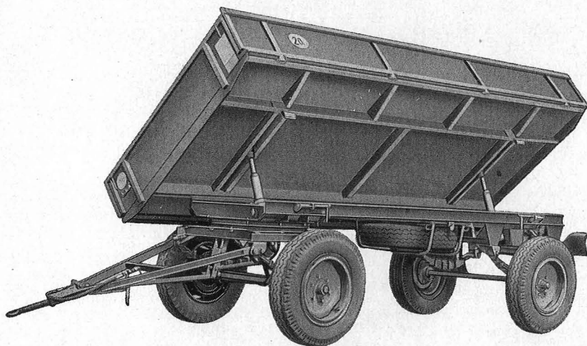
4 t-Traktorenanhänger Typ TK 4 mit hydraulischer Kippeinrichtung
