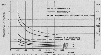
Bild 2. Ladekosten je h Einsatzzeitt<sub>e</sub>) und t Lademenge in Abhängigkeit von der Ladeleistung und Einsatzzeit des Laders T 17**2**
