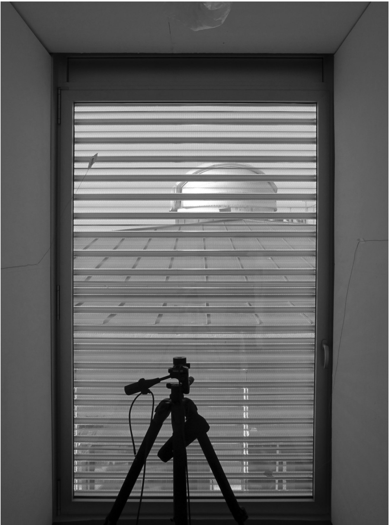
[Abb. 1.98] Fassadenkollektorfeld CPC 12 - 19 % Der effektive Lichtdurchlassgrad des Elements lag bei 13 %
