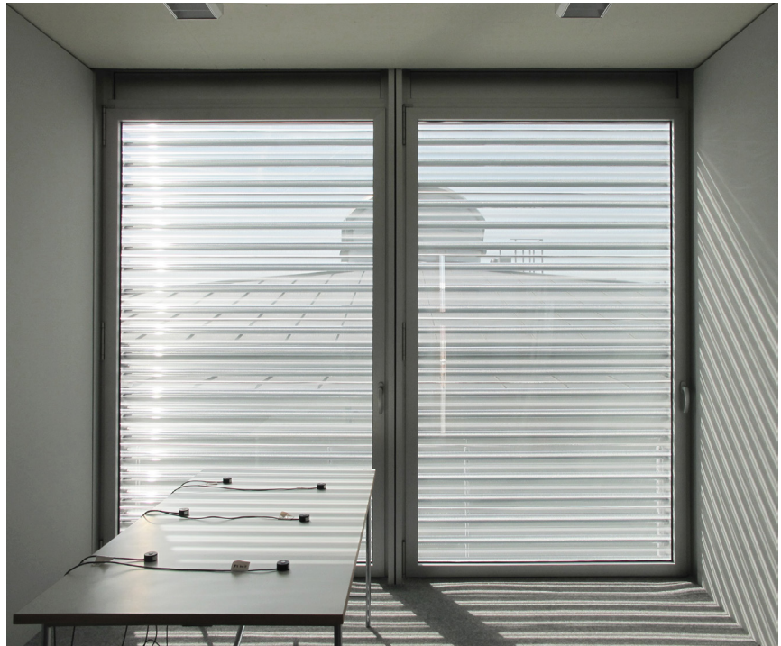
[Abb. 1.114] Arbeitsplatz zur Ermittlung der Blenderscheinungen und Beleuchtungsstärken
