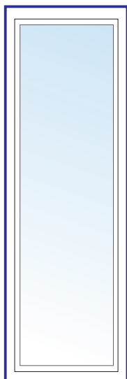
Basismodul als Durchsichtelement (Festverglasung) (offenes System)
