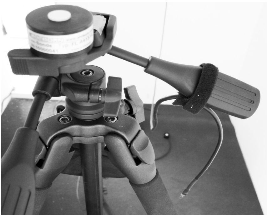
[Abb. 1.61_2] Messstelle der Beleuchtungsstärke und der Raumtemperatur/Luftfeuch- tigkeit und der Mitte des Raumes.
