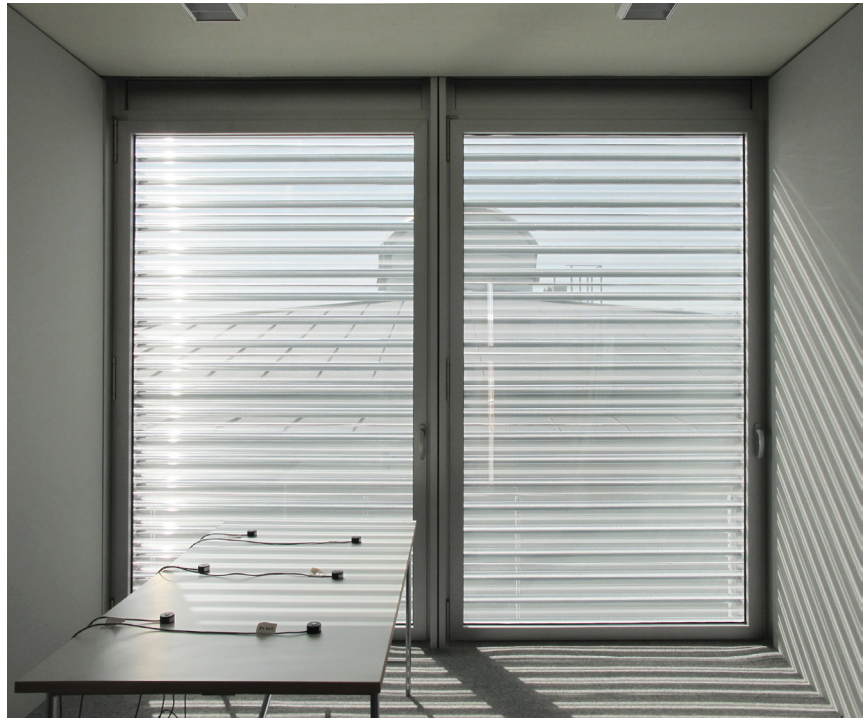
[Abb. 1.112] Arbeitsplatz zur Ermittlung der Blenderscheinungen und Beleuchtungsstärken
