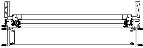
[Abb. 2.143_1] Basismodul mit fest stehendem Sonnenschutz
