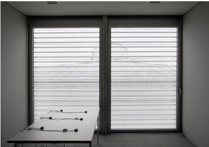
[Abb. 1.55_2] Arbeitsplatz mit Sensoren der Beleuchtungsstärke zur Ermittlung des Tageslichtquotienten
