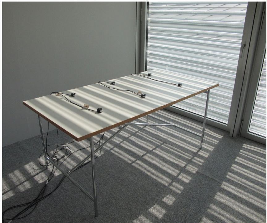
[Abb. 1.113] Arbeitsplatz zur Ermittlung der Blenderscheinungen und Beleuchtungsstärken
