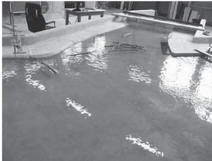
Abb. 4.39: Eintrag einer Schwemmholzgruppe in den Kanal ohne Anprall am rechten Kanalufer im Lastfall  $Q_{\text{Wehr}} = 305 \text{ m}^3/\text{s}$  und  $Q_{\text{Kanal}} = 395 \text{ m}^3/\text{s}$
