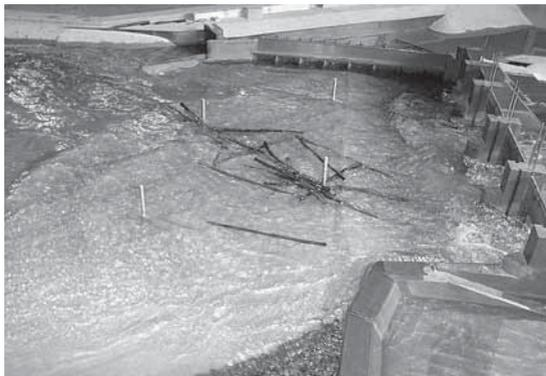
Abb. 4.30: Auflösung und Ausrichtung einer Schwemmholzansammlung an den Leitpfählen 2 und 4
