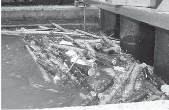
Abb. 3.17: Kompakter, mehrlagiger Verklauskörper im Dreifeldmodell
