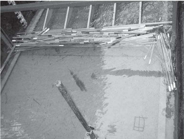
Abb. 3.37: Kompakter, mehrlagiger Verkläusungskörper aus Kunstholz vor flach geneigtem Rechen ( $v = 0,348$  m/s;  $Fr = 0,231$ ;  $\rho_H = 975$  kg/m<sup>3</sup>;  $\alpha = 20^\circ$ )
