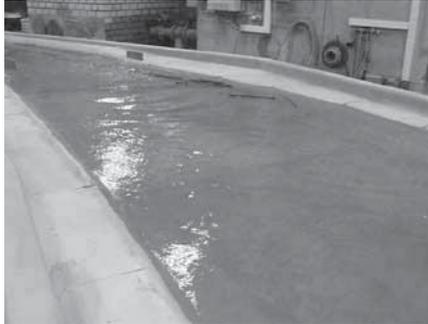
Abb. 4.38: Eintrag einer Schwemmholzgruppe am linken Aareufer für  $Q_{\text{Aare}} = 1650 \text{ m}^3/\text{s}$
