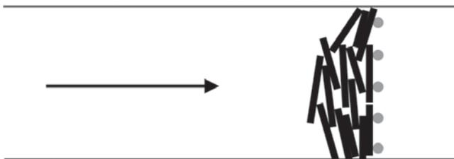
Abb. 2.2: Schematischer Grundriss eines verklauten Schwemmholzrechens senkrecht zur Fließrichtung
