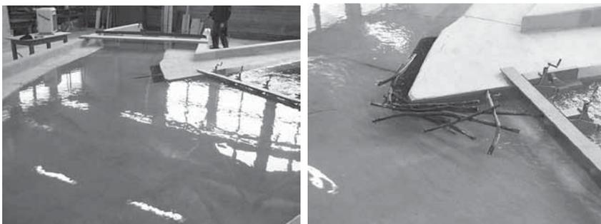
Abb. 4.40: Anprall eines einzelnen Schwemmholzstamms an die rechte Ufermauer am Kanalbeginn (links) und Ansammlung einer Holzgruppe am Trennungsbauwerk zwischen Wehr und Kanal (rechts) im Lastfall  $Q_{\text{Wehr}} = 550 \text{ m}^3/\text{s}$  und  $Q_{\text{Kanal}} = 150 \text{ m}^3/\text{s}$
