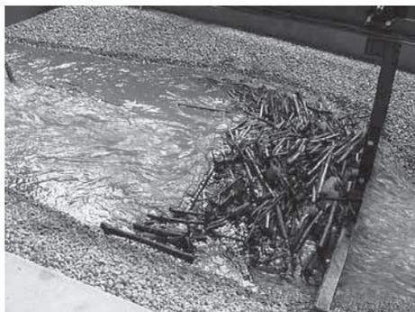
Abb. 2.34: Verklausung eines Schwemmholznetzes im Modellversuch (Foto: Rimböck)
