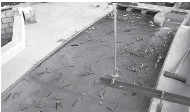
Abb. 4.35: Schwemmholzabfuhr bei vollständig geöffneter HWE ohne Kraftwerksbetrieb
