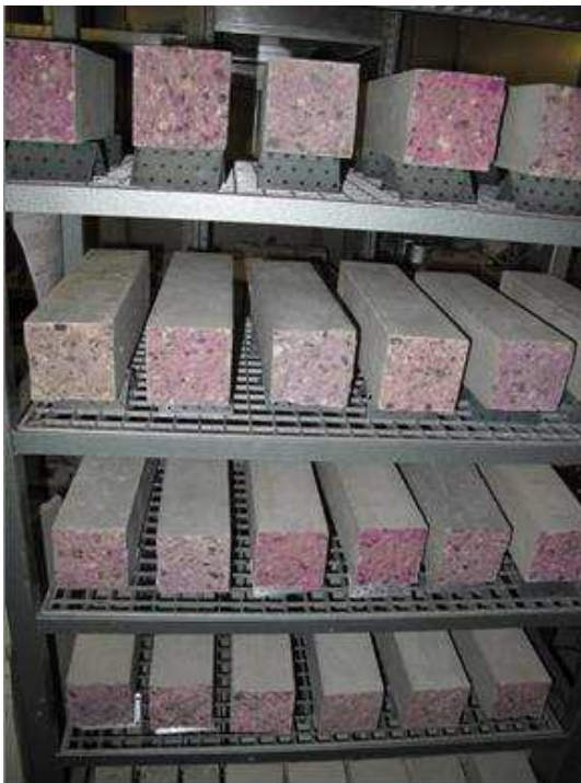
Bild 43: Lagerung der Proben in der Klimakammer des cbm (links), Messung der Carbonatisierungstiefe (rechts; Yu, 2013)
