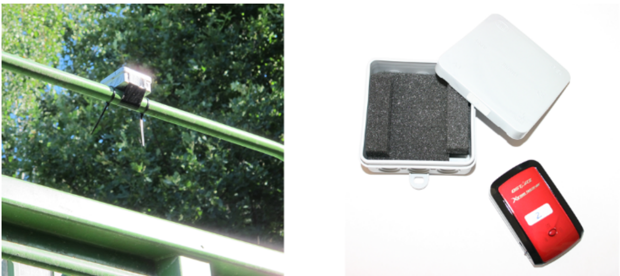
Abbildung 4.2: links: Befestigung am Fahrzeug, rechts: Kunststoffdose mit Polsterung
