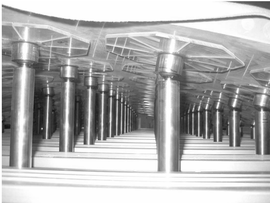
Abbildung 3.8: Formflexible Anlage zur Umformung von PMMA
