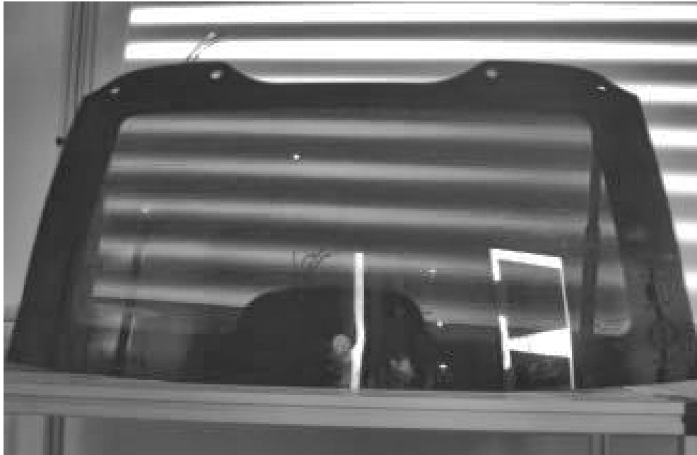
Abbildung 3.12: Bestimmung der resultierenden Verzerrung in Automobilscheiben mit Hilfe des Zebrausters (ROSENBAUM 2003)
