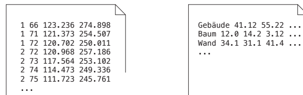
Abbildung 4.1: Beispielhafte Darstellung von plain-text-Daten für Fußgängerpositionen (links) und Geometriedaten (rechts)
