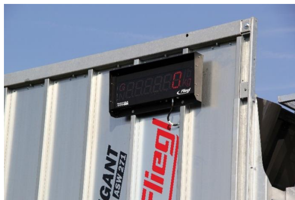
Abbildung 28: Außenanzeige an der Bordwand des FWS (Quelle: Werkbild Fliegl)
