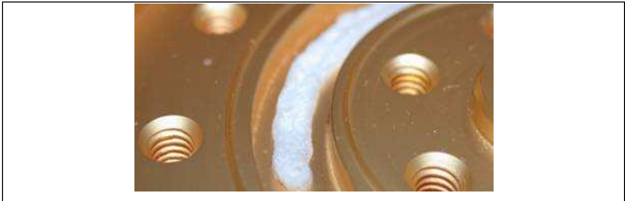
Abbildung 8: Target mit eingetropftem und getrocknetem Targetmaterial
