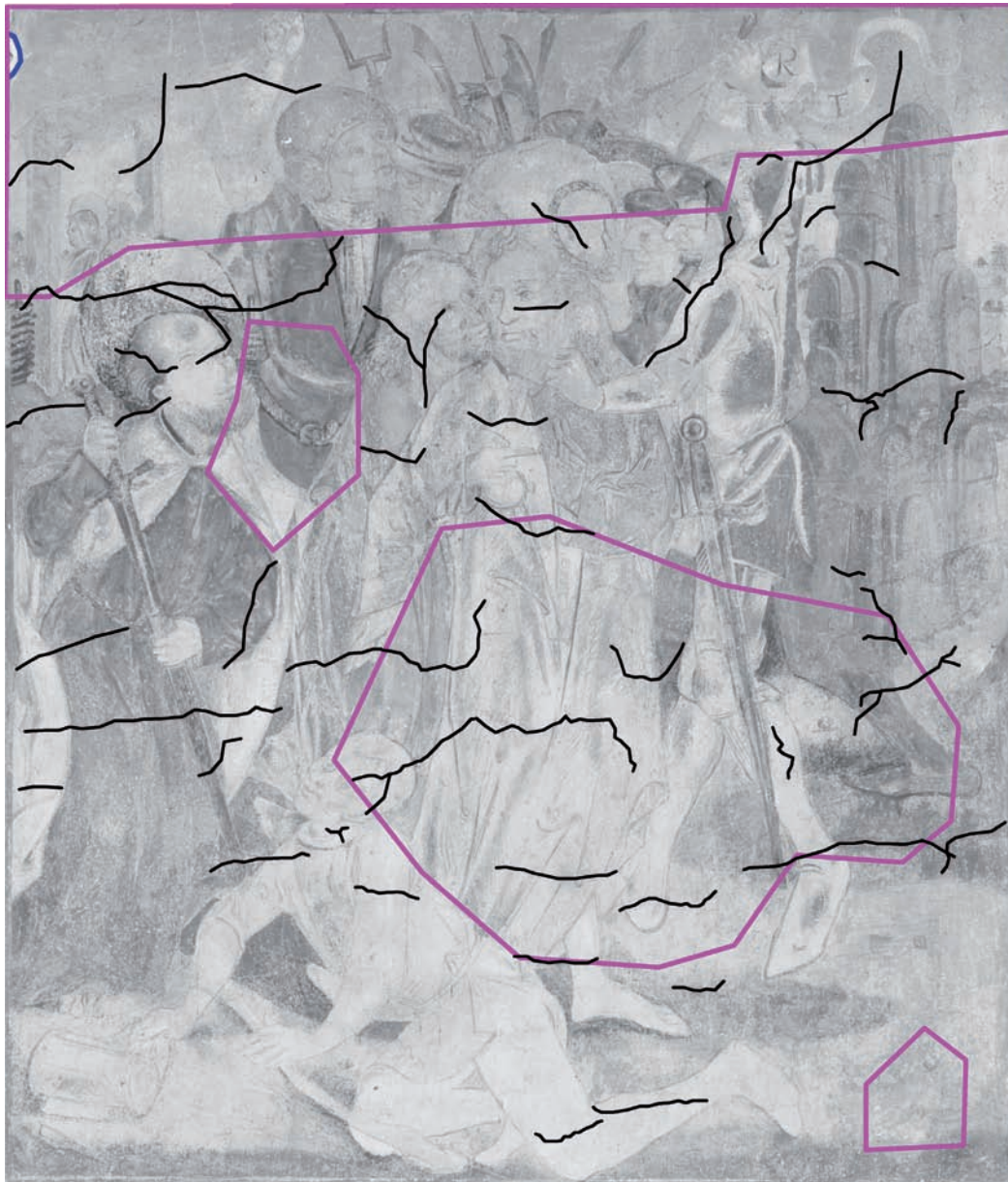
▲ Abb 102: BILDFELD 2, Kartierung, Schäden Putz, Maßstab ca. 1:10
