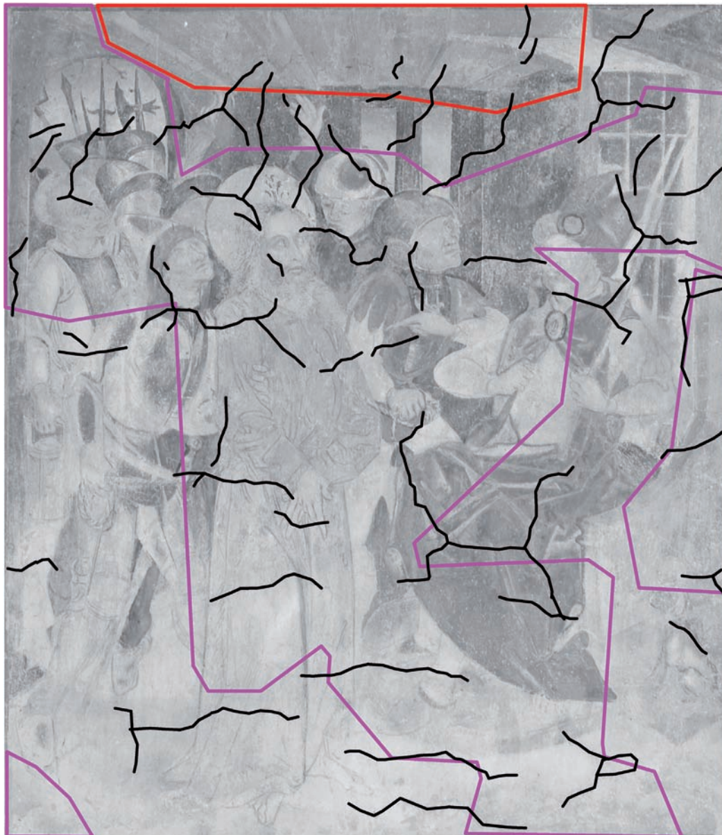
▲ Abb 133: BILDFELD 3, Kartierung, Schäden Putz, Maßstab ca. 1:10
