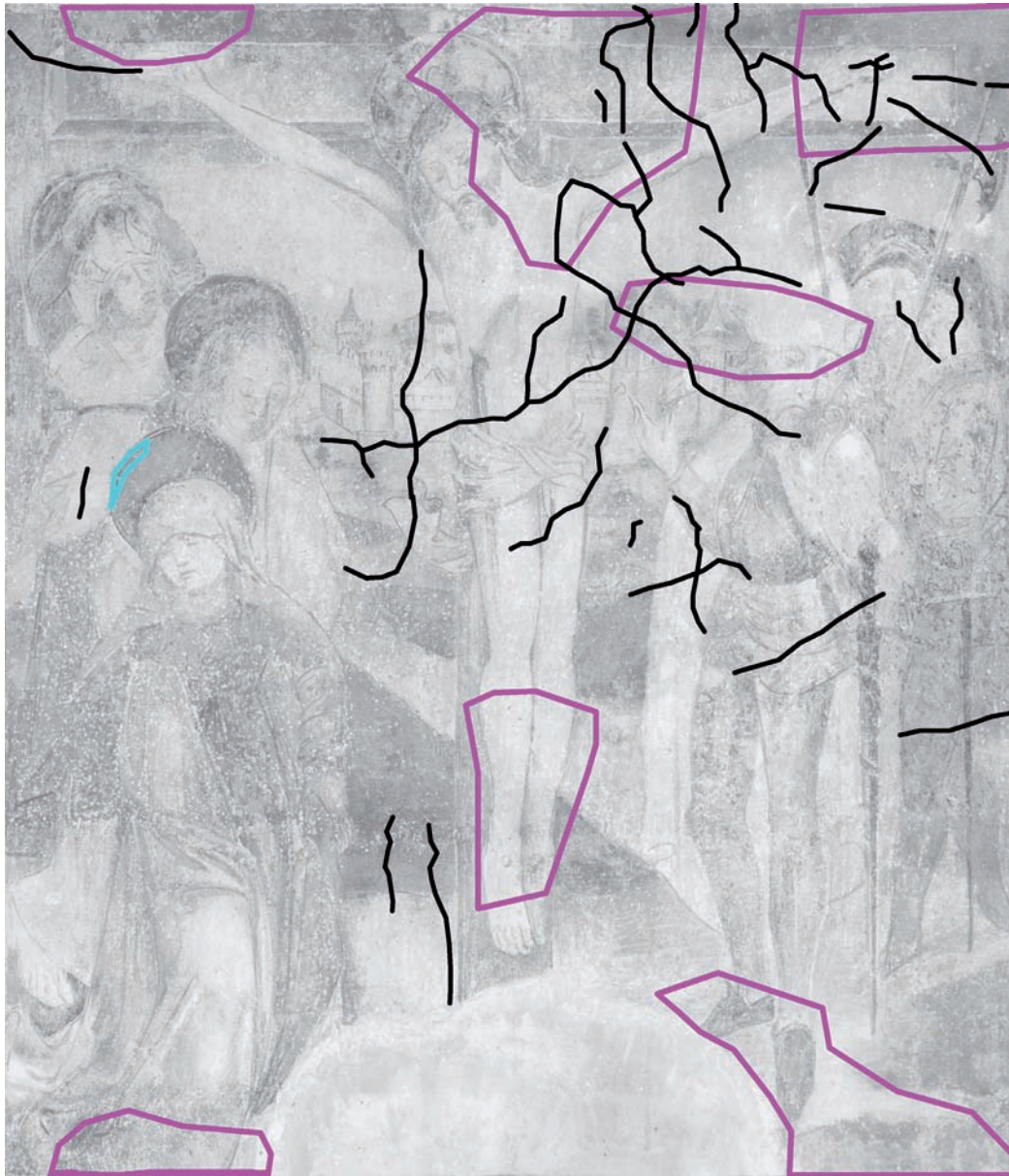
▲ Abb 371: BILDFELD II, Kartierung, Schäden Putz, Maßstab ca. 1:10
