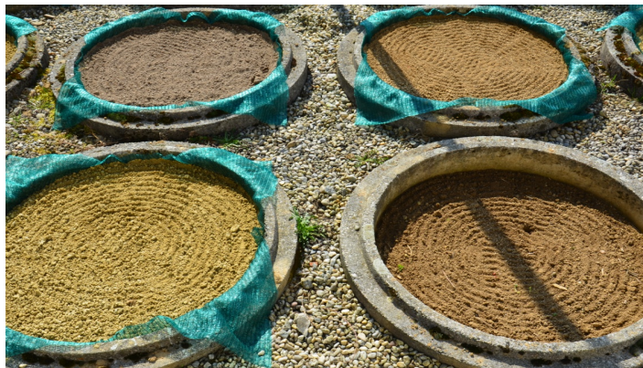
Abbildung 1: Bodenzylinder mit Kunststoffnetzen und 5 cm aufgebrachte Bodenschicht. Böden von links oben nach rechts unten: Su, Lu 1, Lu 2, Lu 3 (Unterboden).
