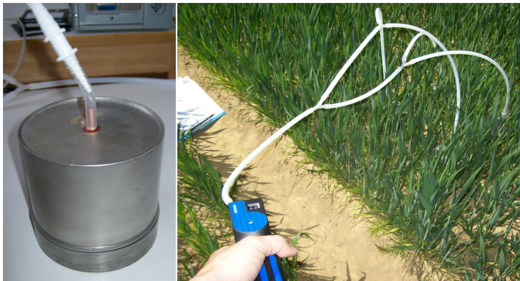
Abbildung 2: Links: Drägerkammer aus Edelstahl mit Verbindungsstück zu den Teflonschläuchen. Rechts: Schlauchverbindungen zum Drägerrohrchen und zur Handpumpe.
