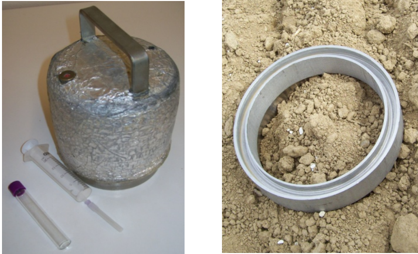
Abbildung 4: Links: Kammer zur Lachgasmessung mit Luftspritze und Vakutainer. Rechts: Metallring im Feld zur dauerhaften Positionierung der Kammern.
