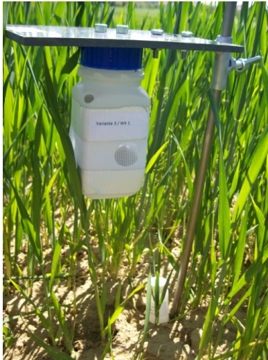
Abbildung 3: Passiv-Flux-Sammler im Weizenbestand mit höhenverstellbarer modifizierter HDPE-Flasche befestigt an einem Kunststoffdach.
