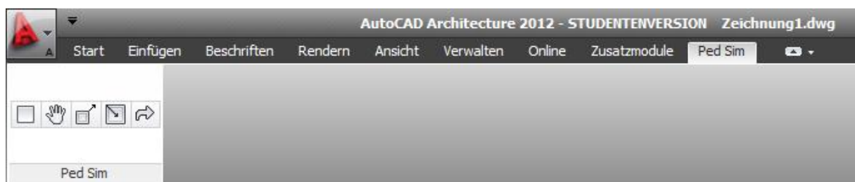
Abbildung 4.1: Screenshot aus AutoCAD mit einer bearbeiteten Benutzeroberfläche. Neu sind hier die Registerkarte Ped Sim mit der Gruppe Ped Sim und die fünf Funktionen.
