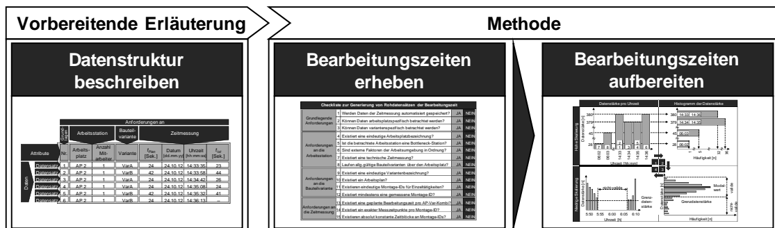
Abbildung 5-1: Überblick über die Methode zur Erhebung und Aufbereitung von Bearbeitungszeiten manueller Montagetätigkeiten
