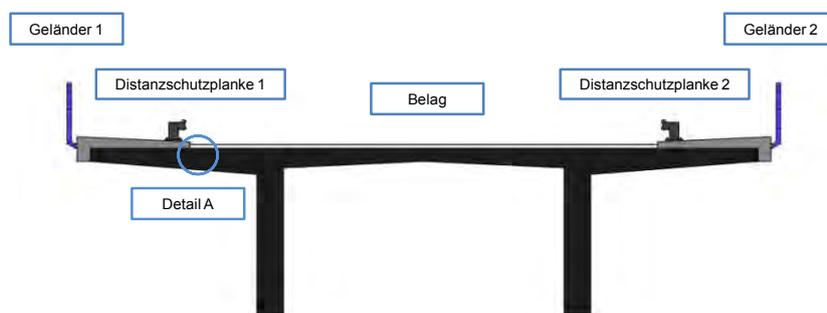
**Abbildung 16- Systembeschreibung Plattenbalkenquerschnitt (Ausrüstungsteile)**
