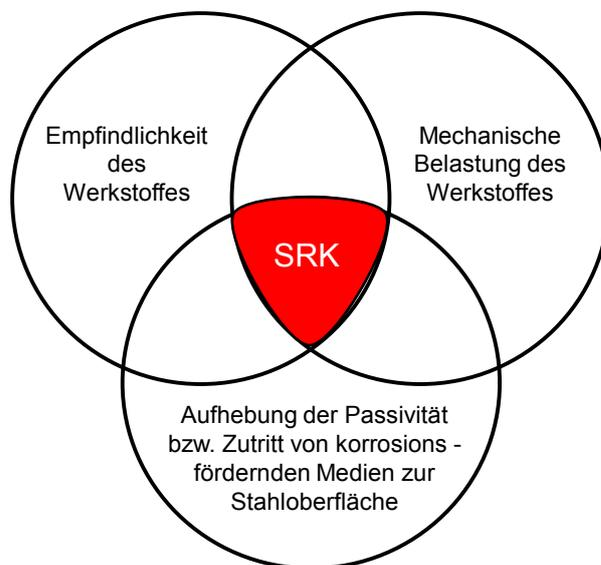
**Abbildung 10- Voraussetzungen einer Spannungsrissskorrosion**
