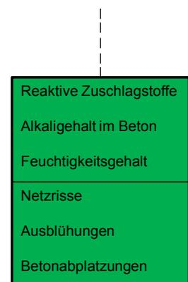
Abbildung 43 – Schadensparameter Alkali-Kieselsäure-Reaktion
