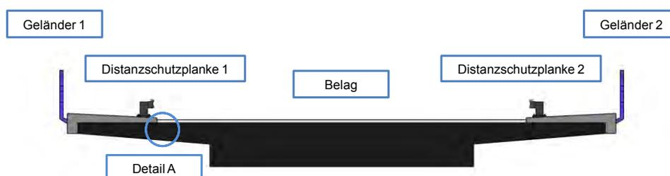
Abbildung 20 - Systembeschreibung Massivplattenquerschnitt (Ausrüstungsteile)
