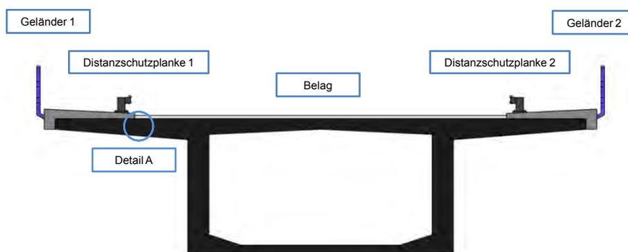
Abbildung 13 – Systembeschreibung Hohlkastenquerschnitt (Ausrüstungsteile)
