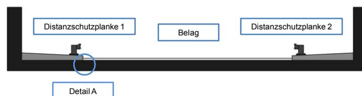
**Abbildung 18 – Systembeschreibung Trogquerschnitt (Ausrüstungsteile)**
