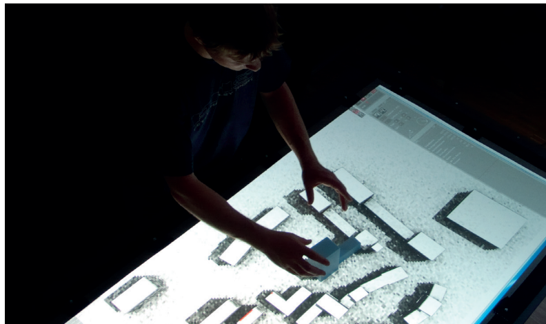
Abb. 25: Digital berechnete Simulationen werden in Echtzeit direkt im Modell angezeigt und erweitern den Ermessensspielraum des Architekten.
