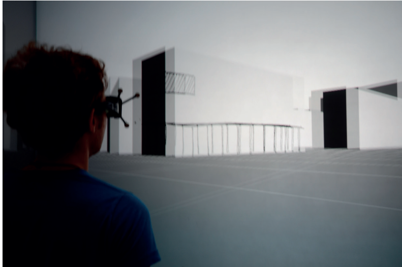
Abb. 42: Immersive Betrachtung der Entwurfsszene in der CAVE. Physische Modelle, digitale Plangrundlage und Handskizzen werden in Echtzeit übertragen und stereoskopisch angezeigt.
